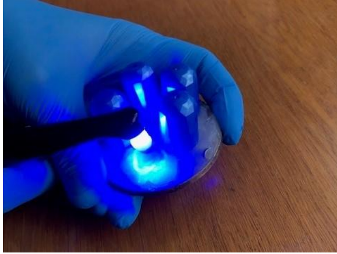
Şekil 3.4.3: Diğer numuneler opak plastik örtü ile korunmaya devam ederken rezin kompozit polimerizasyonunun gerçekleştirilmesi
