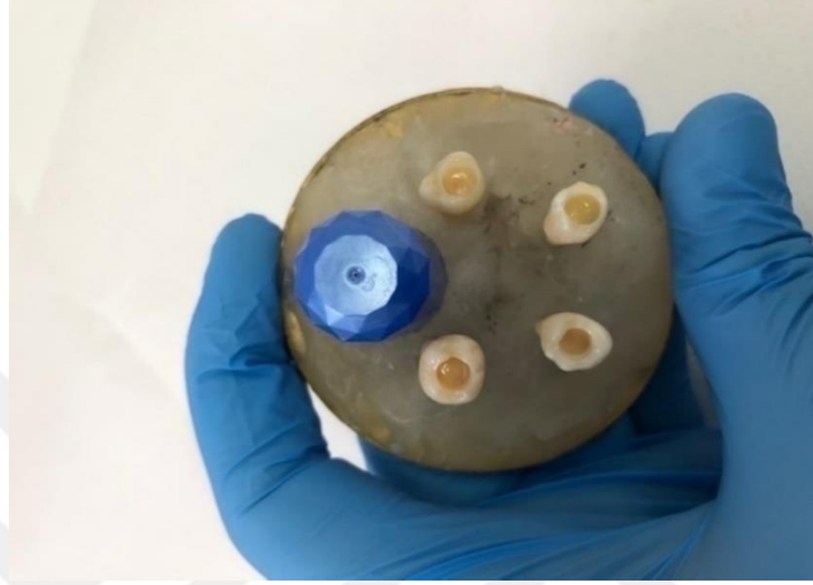
Şekil 3.4.1: İstenmeyen polimerizasyonu önlemek için kompozit uygulanmış numunenin opak plastik örtü ile örtülmesi
