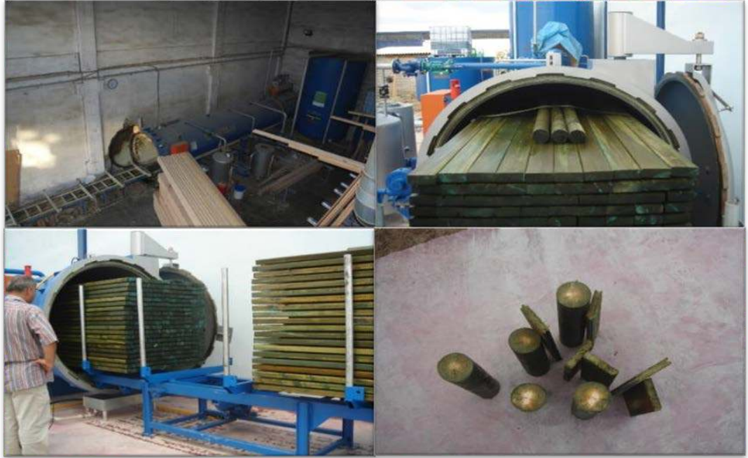
Şekil 1.8 : Emprenye aşamaları(emprenye giriş, emprenye çıkış ve emprenye maddesi nüfuz ettirilmiş ahşap malzeme (Derya İlhan kişisel arşivi, 2021).
