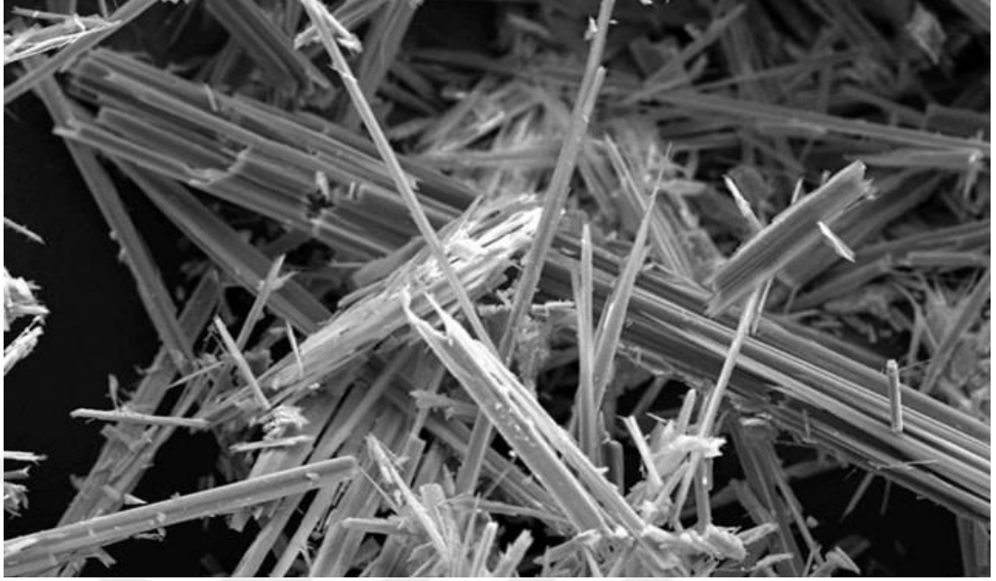
Şekil 4.126: Asbest liflerinin elektron mikroskobu altındaki iğnemsî yapısı
