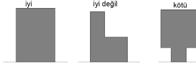
Şekil 2. 3 Düşeyde Bina Düzenlemesi [12]
