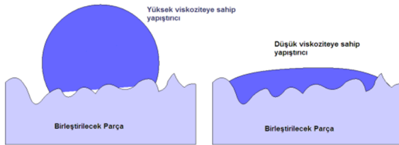
Şekil 1.7 Viskozitenin yapışma kalitesine etkisi [11]
