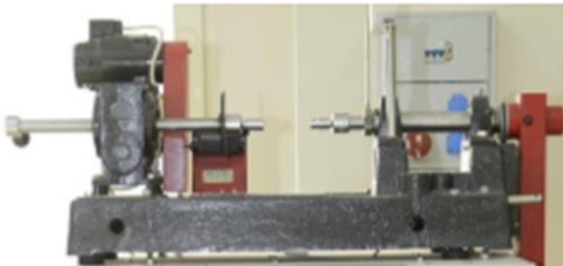
Resim 3.5 Shimadzu AG – X marka burulma cihazı
