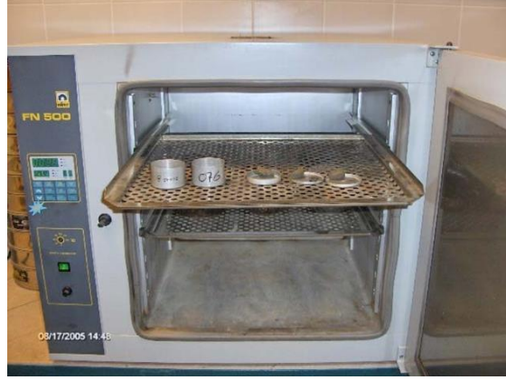
Şekil 5.2. Tartılan zemin numunelerinin etüve konulması
