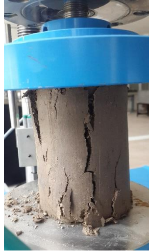
Şekil 5.20. Serbest basınç deneyi
