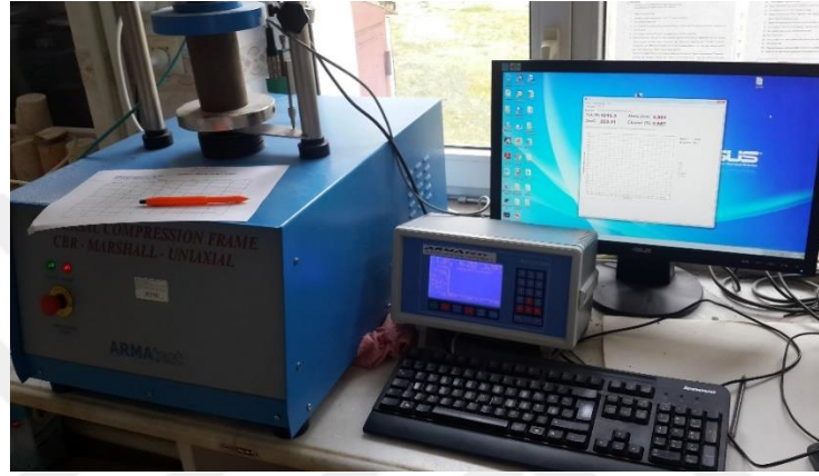
Şekil 5.19. Serbest basınç deney sistemi
