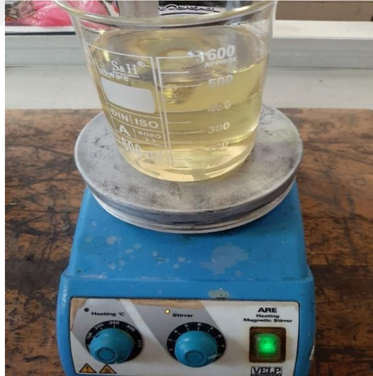
Şekil 4.6. Dizel ve bütanol yakıtlarının karıştırılması
