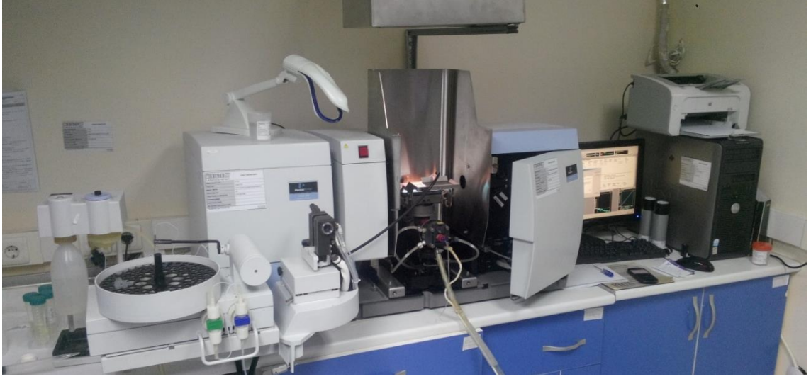
Şekil 2.2: Atomik absorpsiyon spektroskopisi cihazı.
