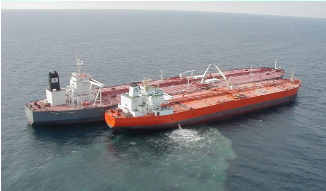
Şekil 3-2: Kirli balast boşaltım görüntüsü.
