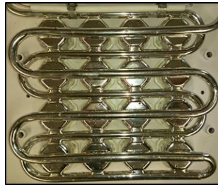
Şekil 2.4 : Sprej tipi ticari buz makinesinin buz kabı ve evaporatör yapısı.
