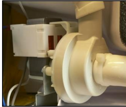
Şekil 2.8 : Sprej tipi ticari buz makinasında kullanılan pompa.
