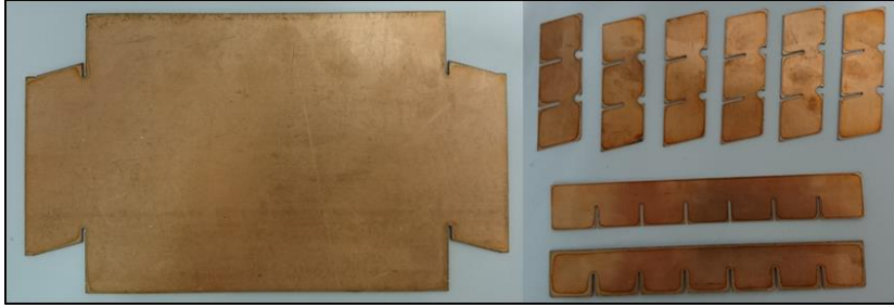
Şekil 5.1 : Buz kabını oluşturacak yapıların lazer kesim sonrası görünümü.
