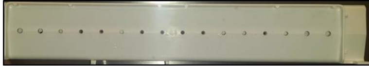
Şekil 1.25 : Şelale tipi ticari buz makinasında suyu buz kabı üzerine dağıtan yapı.
