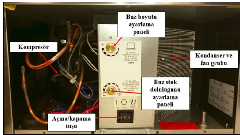
Şekil 1.20 : Sprey tipi ticari buz makinasının alt kısmının yapısı.
