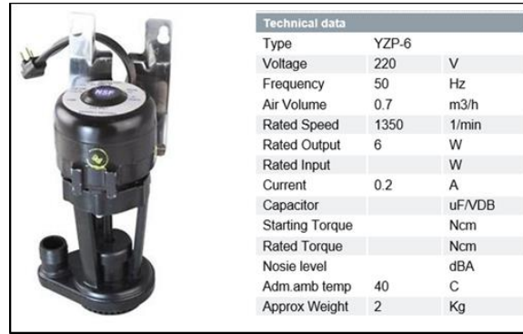
Şekil 1.26 : Şelale tipi ticari buz makinasındaki pompaya ait teknik bilgiler [16].
