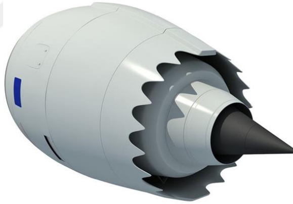
Şekil 4.22. Turbofan motordaki egzoz çıkışı- Rolls Royce Trent 1000 [44]
