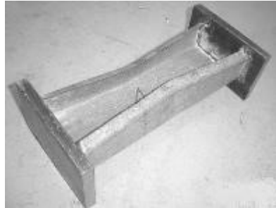
Şekil 10. C kesitli hafif çelik profilin deney sonu görüntüsü (Lam vd., 2006)
