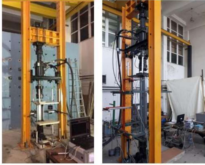
Şekil 16. Deney anında 2 farklı boydaki sigma kesitli elemanın görüntüsü
