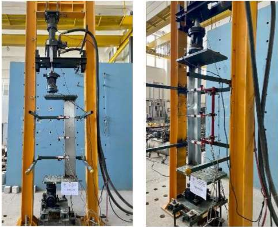
Şekil 26. Deney düzeneğinin farklı açılardan görünümüleri
