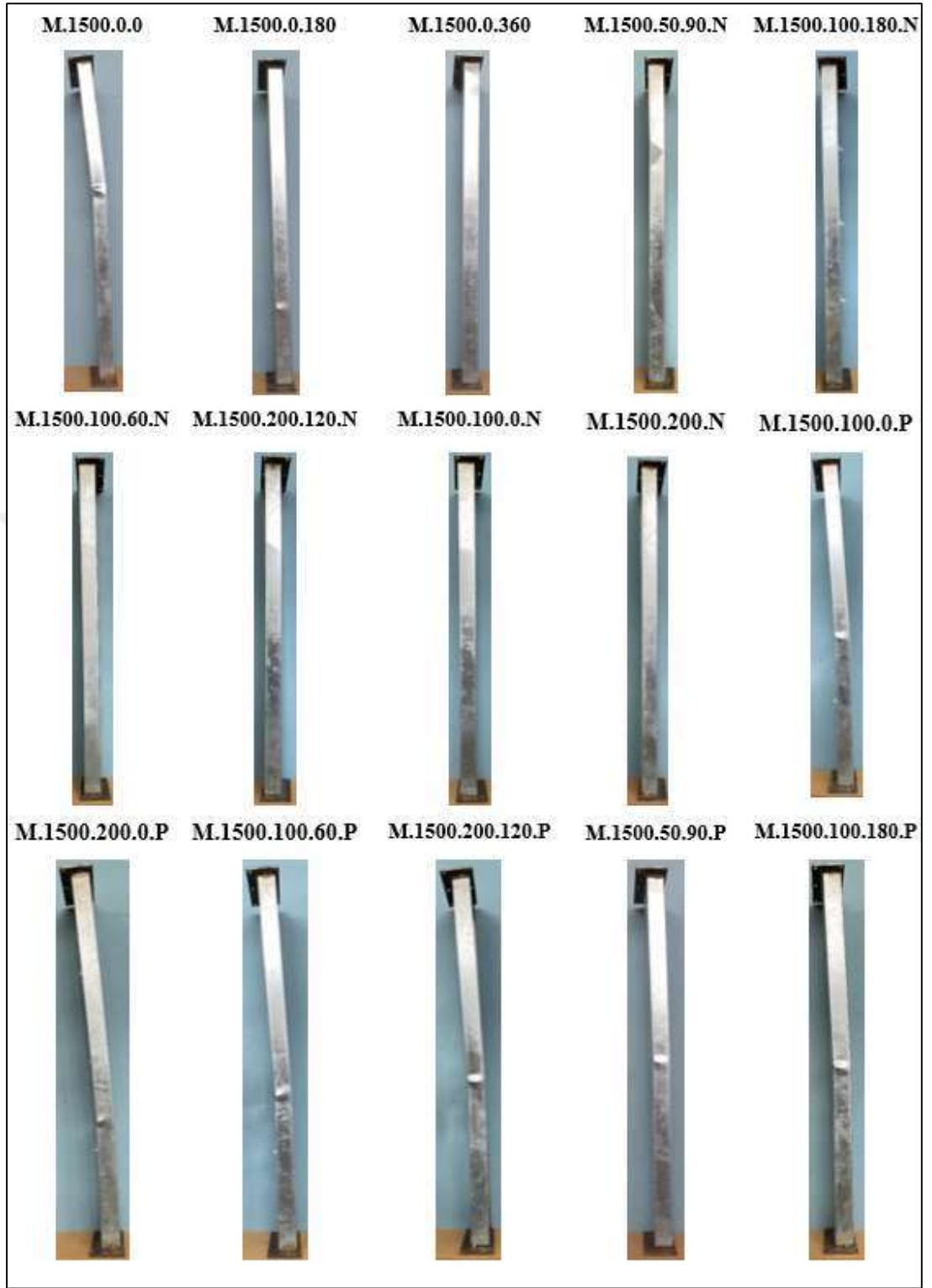
Şekil 56. Monotonik yüklemeye ait deney elemanların deney sonu yandan görünüşleri
