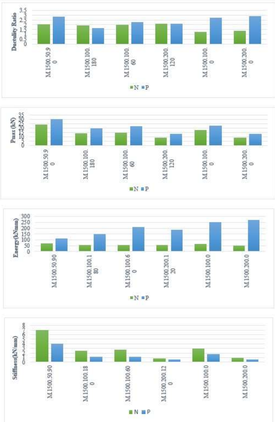
Şekil 55. Monotonik yüklemelerde dudakların gerilme durumuna göre numunelerin karakteristik özellikleri
