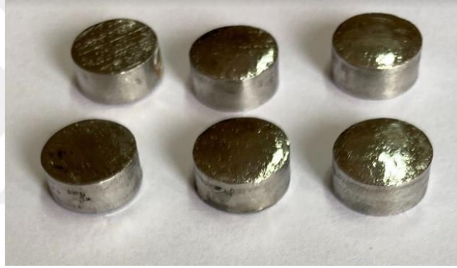
Şekil 4-2: Korozyon testi sonrası lazer sinterleme ile üretilen Co-Cr örnekler
