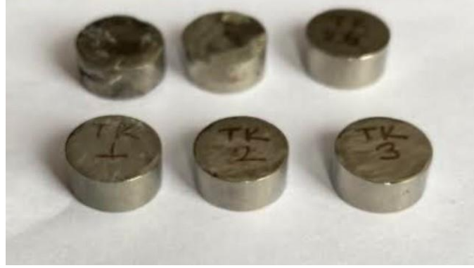
Şekil 4-4: Korozyon testi sonrası CAD-CAM frezeleme ile üretilen Ti6Al4V numuneler
