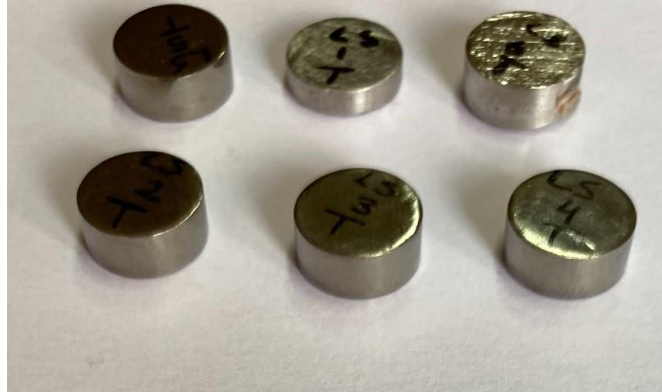
Şekil 4-3: Korozyon testi sonrası lazer sinterleme ile üretilen Ti6Al4V numuneler
