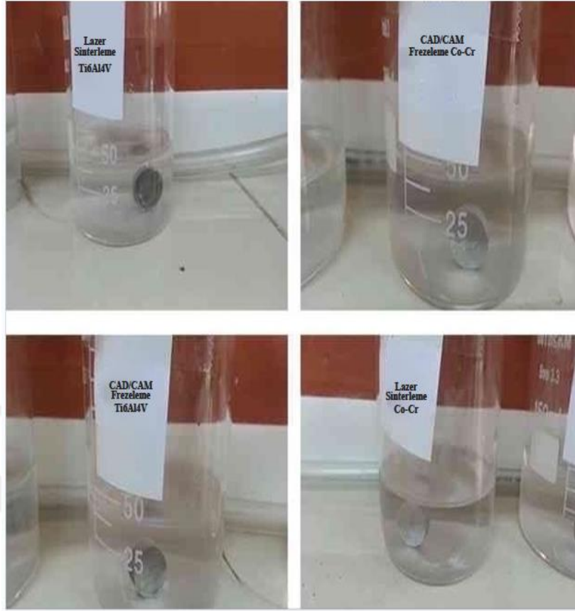
Şekil 3-12: Statik daldırma testlerinde kullanılan numuneler
