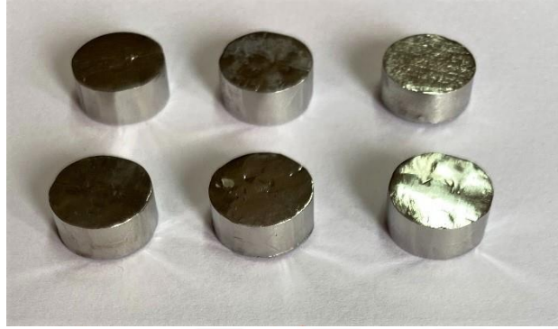
Şekil 4-1: Korozyon testi sonrası CAD/CAM frezeleme ile üretilen Co-Cr örnekler
