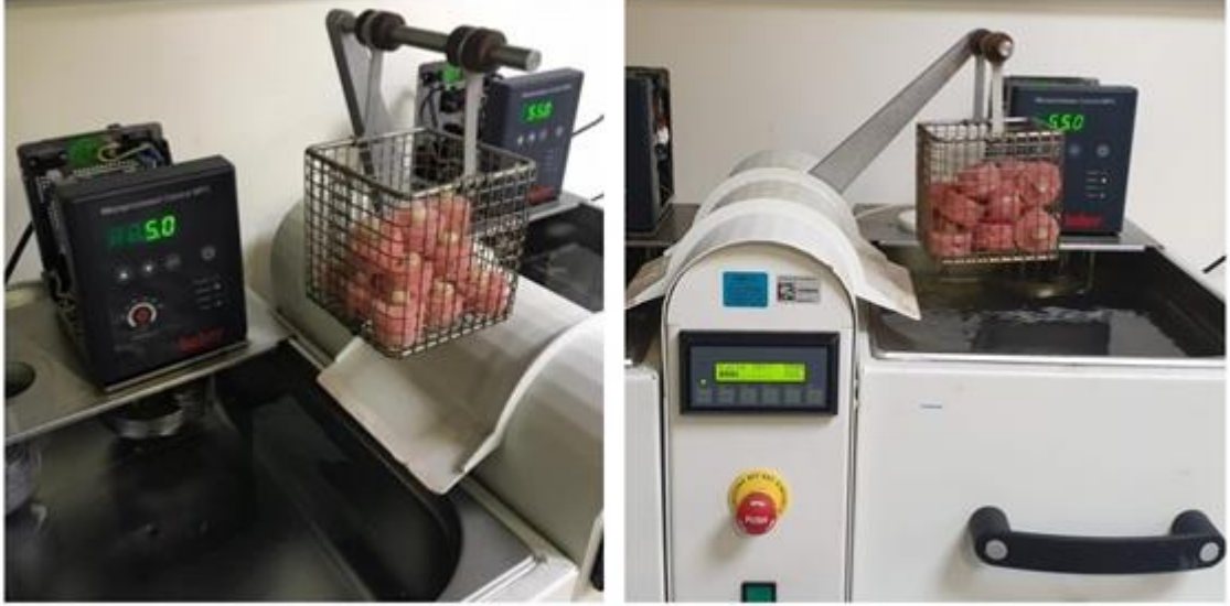
Şekil 3.19. Termal siklus cihazında termal yaşlandırma yapılan örnekler
