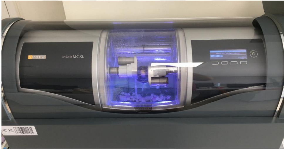
Şekil 24-Cerec MC XL Cihazında Kazıma İşlemi
