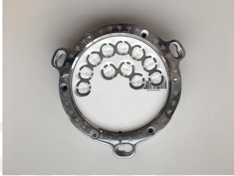
Şekil 27-Zirkonya Örneklerin Kazıma Sonrası Görüntüsü
