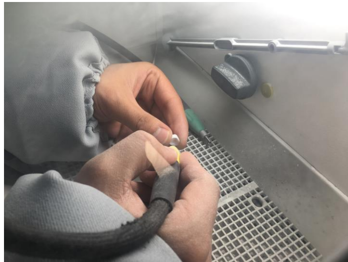
Şekil 49-Renfert Kumlama Cihazında Zirkon İç Yüzeylerinin Kumlanması
