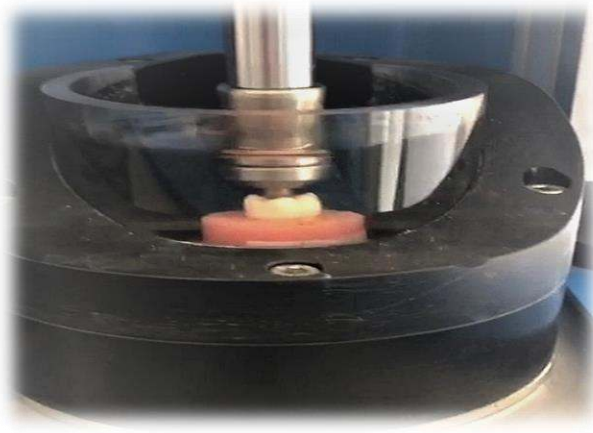
Şekil 26. Örneklerin çiğneme simülatörü ile yaşlandırma işlemi
