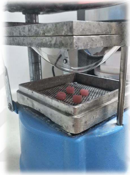
Şekil 21. Akrilik kopyaların SX plağa basılması işlemi
