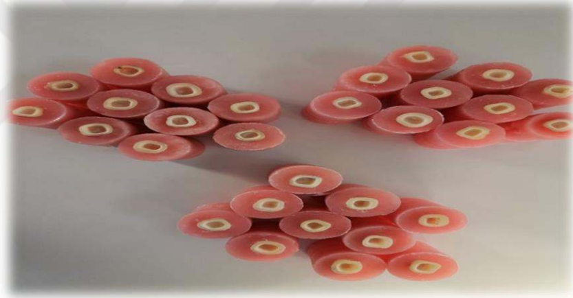
Şekil 11. Kök kanal tedavisi tamamlanan örnek dişlerin akrilik rezinlere gömülmesi
