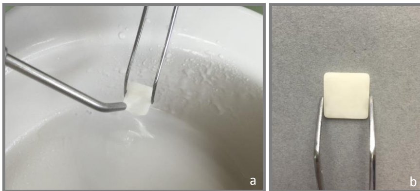
Resim 42. a: Örnek yüzeyinin hava su spreyi ile yıkanması b: Asitleme sonrası yüzeyin görüntüsü
