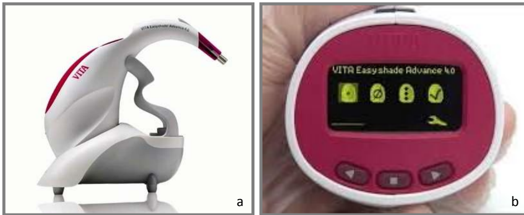
Resim 50. a, b: Renk ölçümünde kullanılan spektrofotometre
