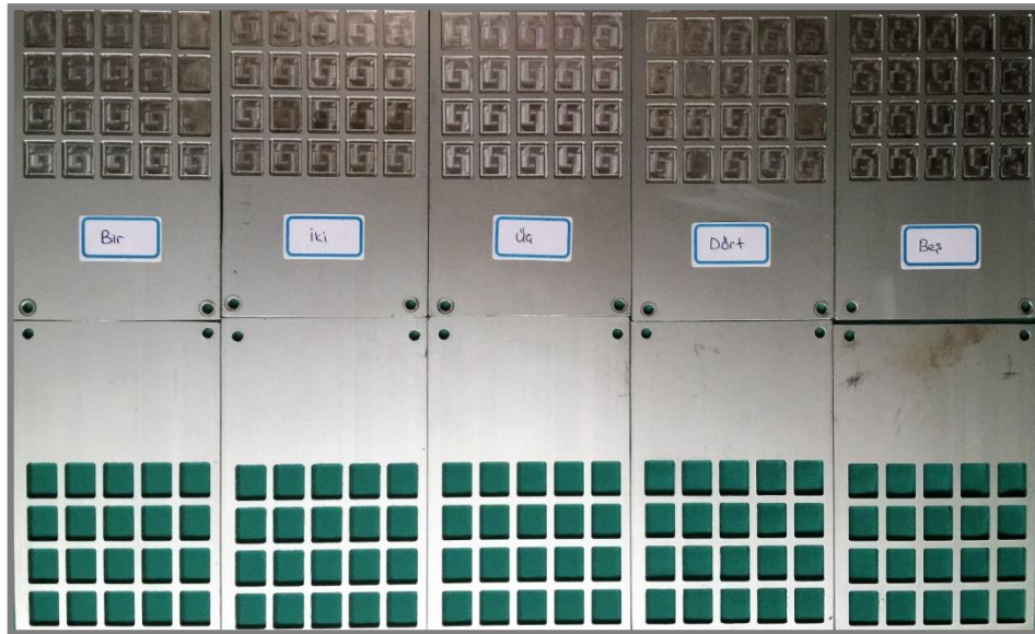
Resim 52. UV yaşlandırma işlemi için hazırlanan metal kalıpların görüntüsü
