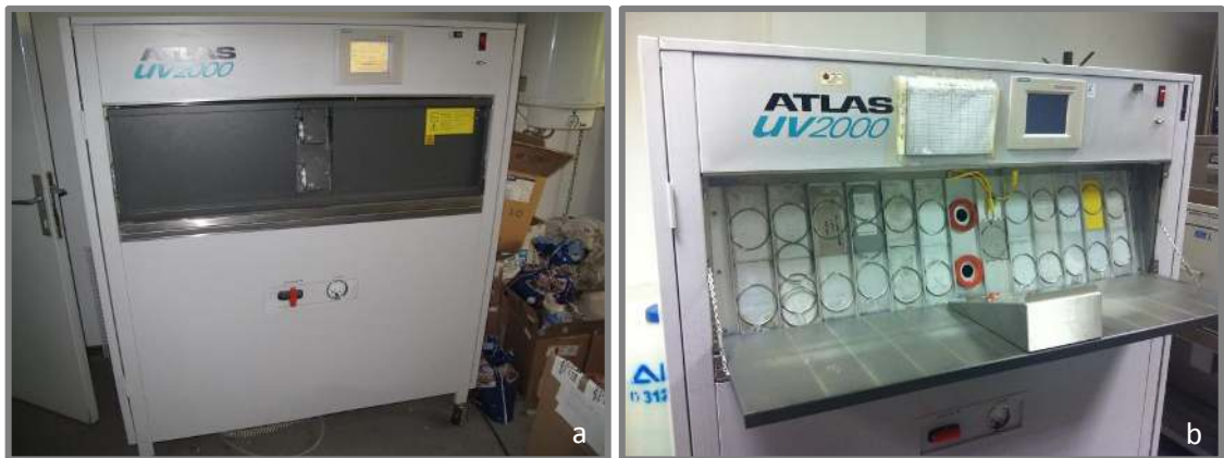
Resim 54. a: Yaşlandırma cihazı (Atlas UV 2000) b: Test bölmesinin görünümü
