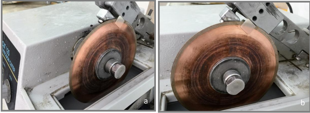
Resim 24. a, b: Örneklerin düşük hızlı kesme cihazı ile elde edilmesi
