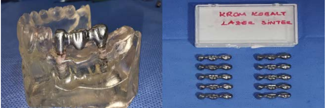
Şekil 3.10. Çalışmada kullanılan DMLS Co-Cr altyapılar
