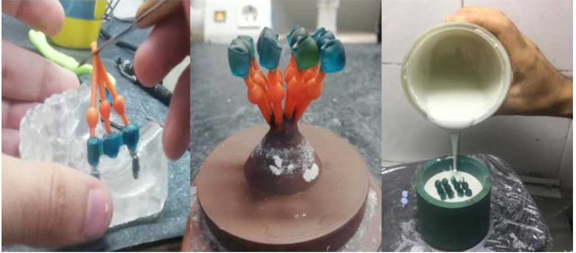
Şekil 3.4. Rezin esaslı altyapıların tijlenmesi ve manşete alınması
