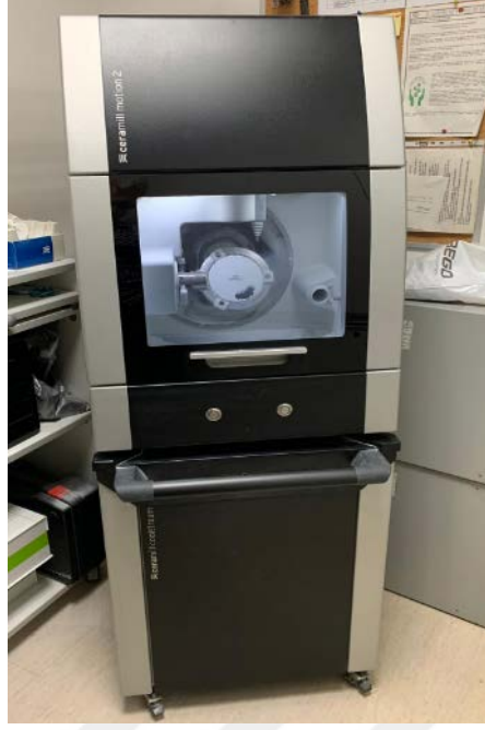
Şekil 3.12. Zirkonyum kazıyan CAD/CAM cihazı
