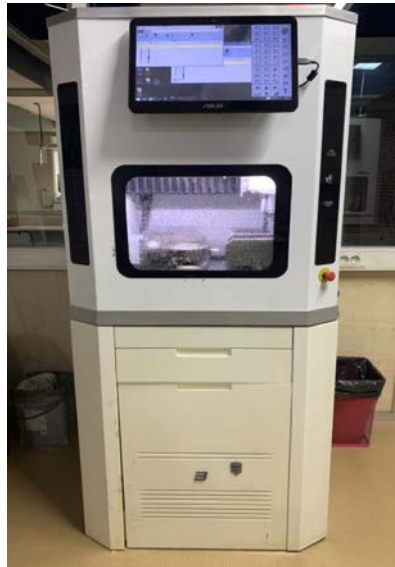
Şekil 3.7. Metal blok kazıyan CAD/CAM cihazı
