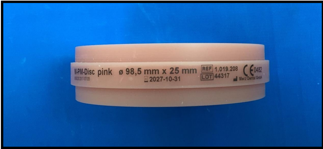
Şekil 3.2 Prepolimerize akrilik reçine blokların görünümü
