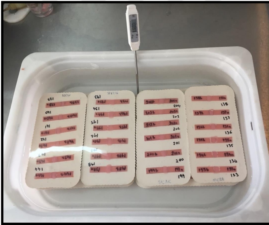
Şekil 3.11 Örneklerin termostatik olarak kontrol edilen 60^\circ\text{C} 'deki su banyosunda bekletilmesi
