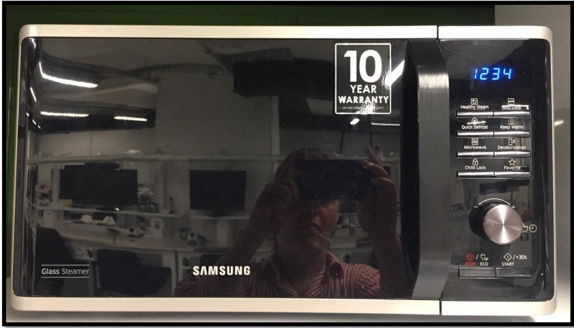
Şekil 3.12 Örneklerin mikrodalga enerjisi ile ilave polimerizasyon döngüsüne tabii tutulduğu ev tipi mikrodalga fırının görünümü
