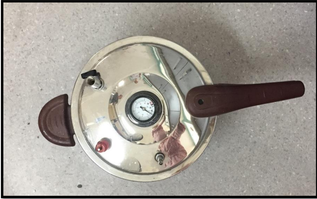
Şekil 3.13 Kimyasal yolla polimerizasyon işleminde kullanılan basınçlı tencerenin görünümü
