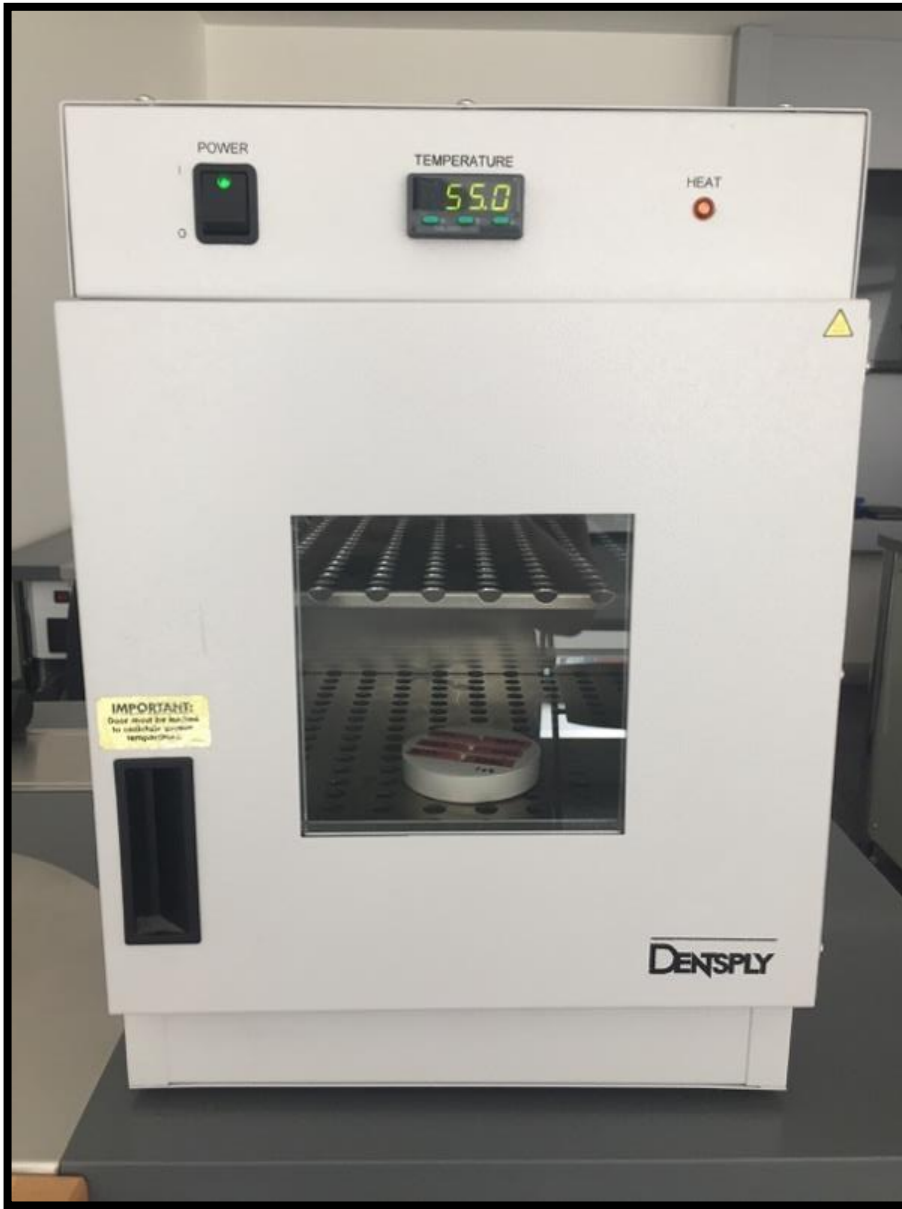
Şekil 3.15 Alçı tamir kalıbın ısıtılmasında kullanılan fırının görünümü
