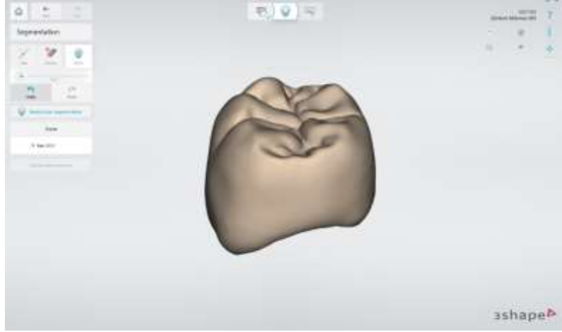
Şekil 3.14: 3Shape Yazılımı ile Tasarlanan Knife-Edge Kesim Tipine Ait Kuronun Tasarımı.
