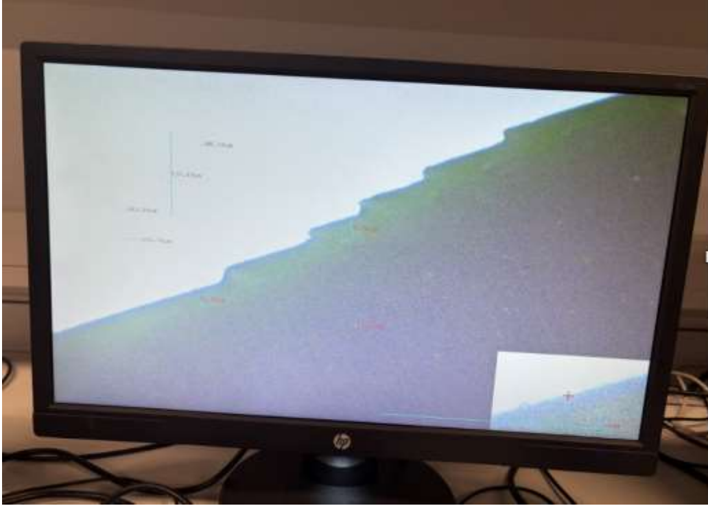
Şekil 3.22: Nikon Software Üzerinden Yapılan Marjinal ve İnternal Aralık Değerleri için Yapılan Ölçüm.
