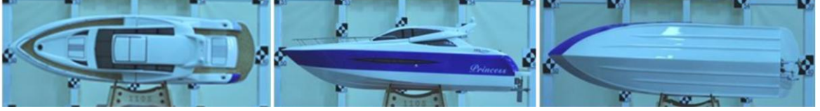
Şekil 4.22. Yersel fotogrametri yöntemi ile model geminin üst, ön ve alt görüntüsü [41].
