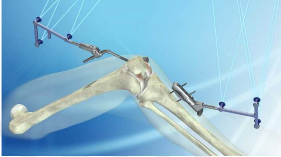
Şekil 6.43. Robotik cihaz ile kemik konumu algılayıcı robotik kolların takılması OMNIBotics [60].
