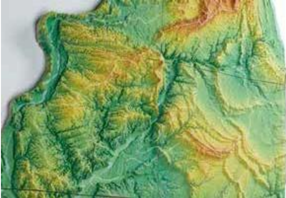
Şekil 4.26. Havadan topografik yöntemiyle oluşturulan 3B katı model harita [43].
