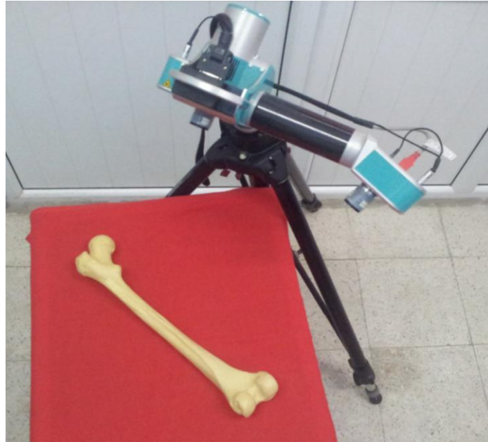
řekil 6.52. Model ürünün tarama sehpasına konulması (Breuckmann SmartSCAN)
