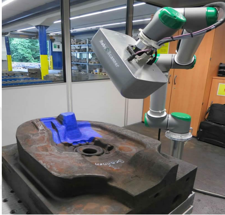
Şekil 4.10. Kalite kontrol için optik kaporta kalıp taraması [30].
