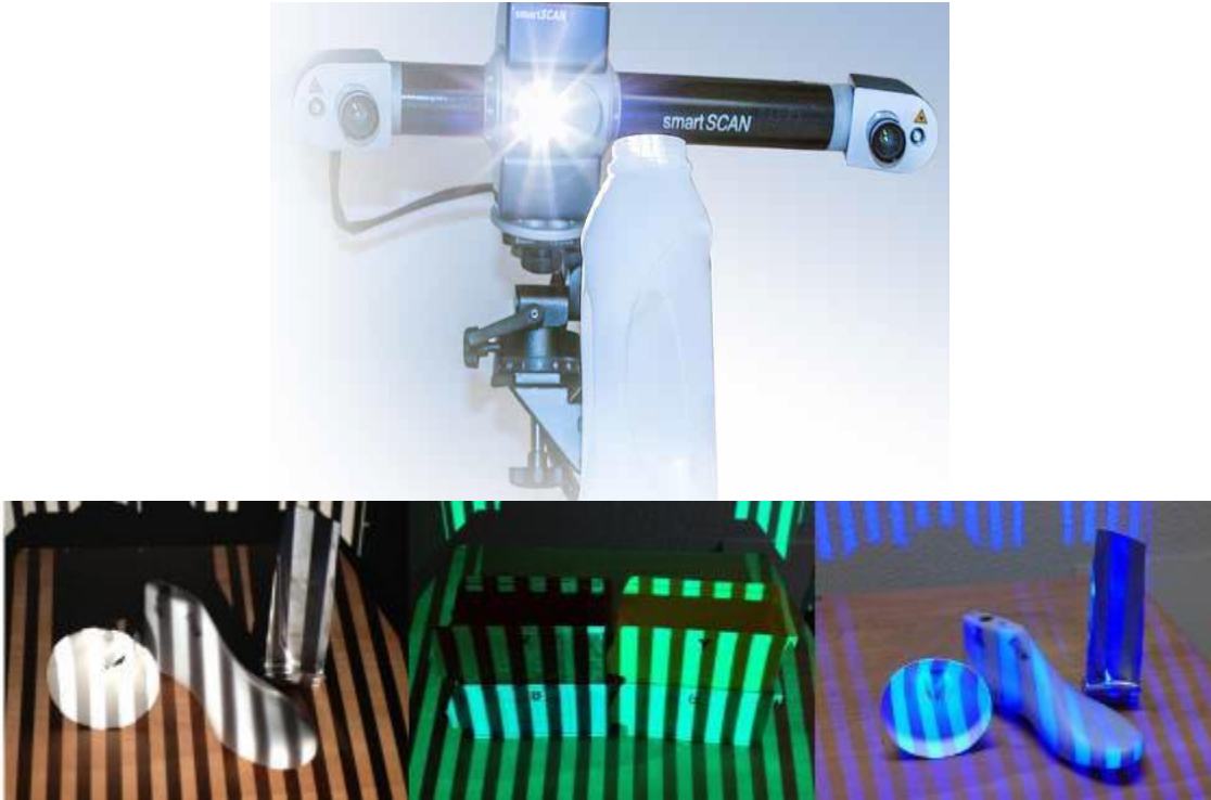
Şekil 4.11. Işık kaynağı projeksiyondan farklı renklerde saçaklar halinde yansımaları [32].
