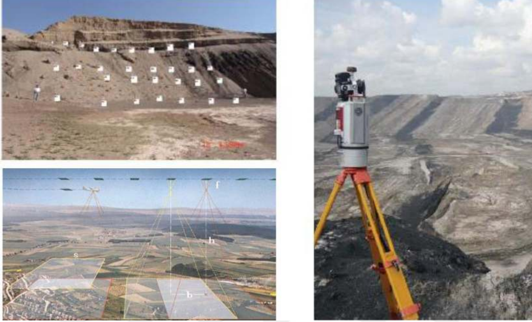
Şekil 4.25. Topografik yöntem ile havadan ve yerden foto çekimi [42].
