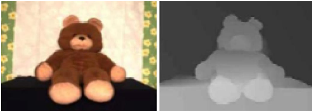
Şekil 4.21. Stereo analiz sistemiyle elde edilen derinlik haritası [40].
