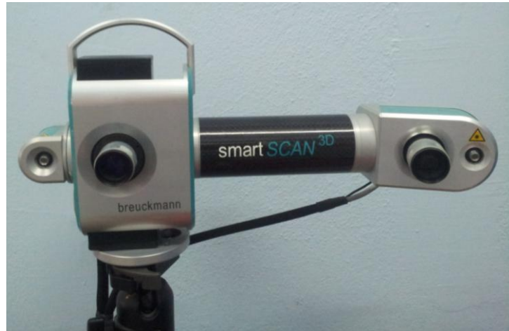
Şekil 6.50. Optik tarama cihazı (Breuckmann SmartSCAN)
