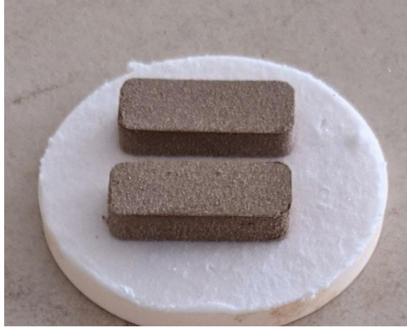
Şekil 5.4. Üç nokta eğme testi için hazırlanan numune örnekleri.
