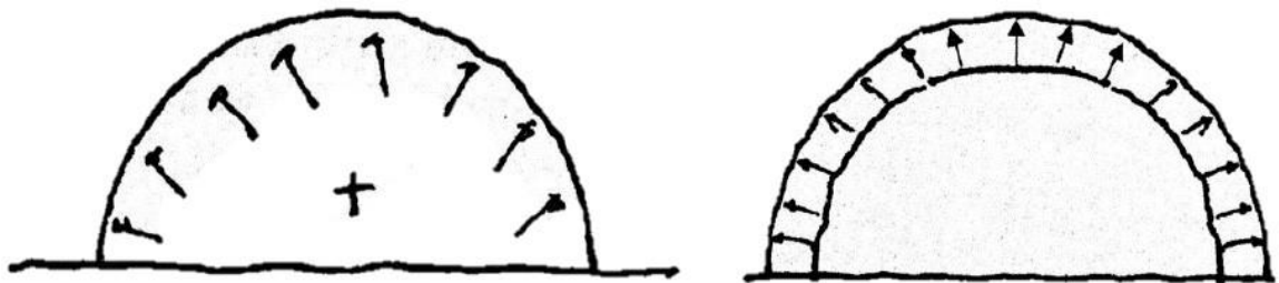
Şekil 3.9. Tek tabakalı ve çift tabakalı sistem basınç karşılaştırması (URL-16, 2019)
