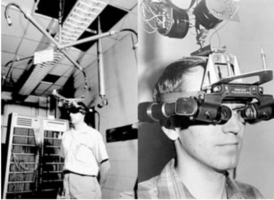
Görsel 2. 43. Ivan Sutherland ve Bob Sproull, “Demokles’in Kılıcı”, HMD (head-mounted display) cihazı VR gözlükler, 1968.
