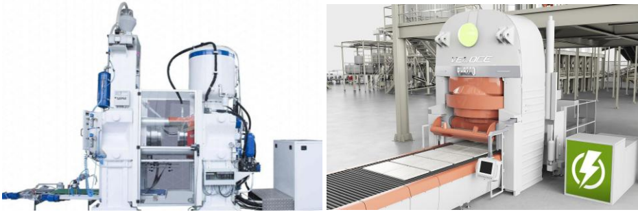
Fotoğraf: Sofra takımı ürünleri için yatay tek kafalı pres ve Elektrikte %25'e kadar tasarruf hidrolik presleri.
