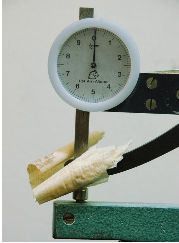
Resim 36. Talaş Kalınlığının Ölçümü
