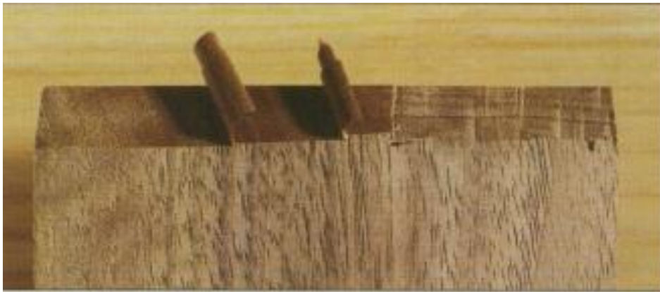
Resim 33. Bir ahşap parçada solda keskin bir alet pürüzsüz bir yüzey bırakırken, sağda kör bir alet pürüzlü bir yüzey bırakmıştır.
