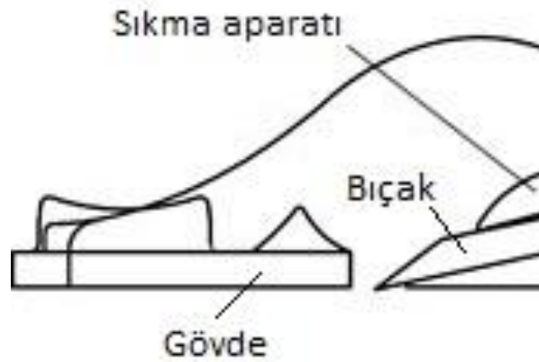
Şekil 41. Avuç Rendelerinin Bıçak yerleşim Düzeni
