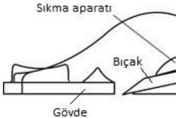
Şekil 26. Standart Bir Avuç Rendesinde Kesici Çelik Yerleşimi
