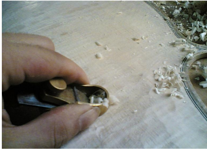
Resim 30. Parmak Rende ile Bir Çello Kapağının Ölçeklendirilmesi
