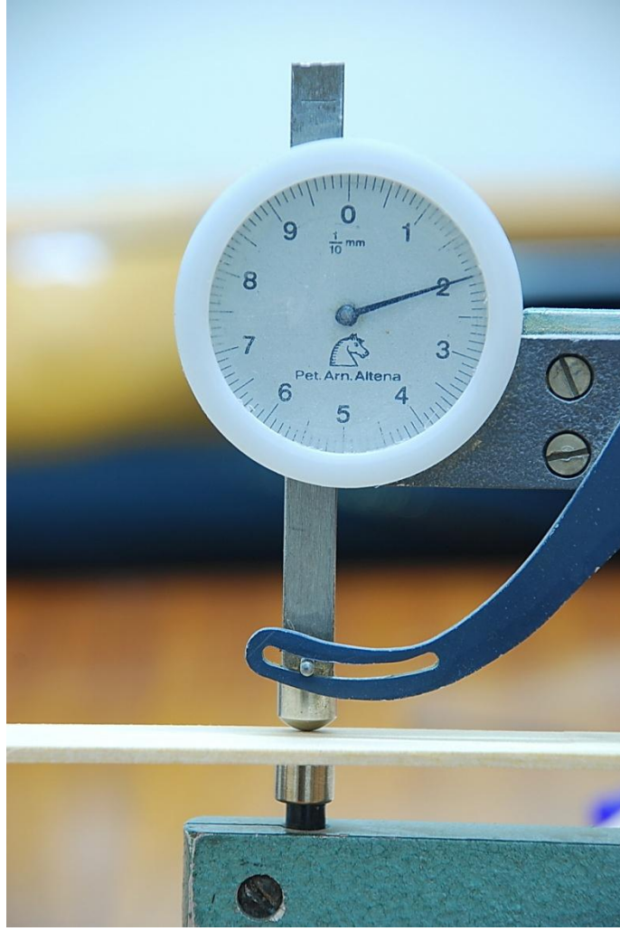
Resim 41. Test Çıtalarının Ölçümü
