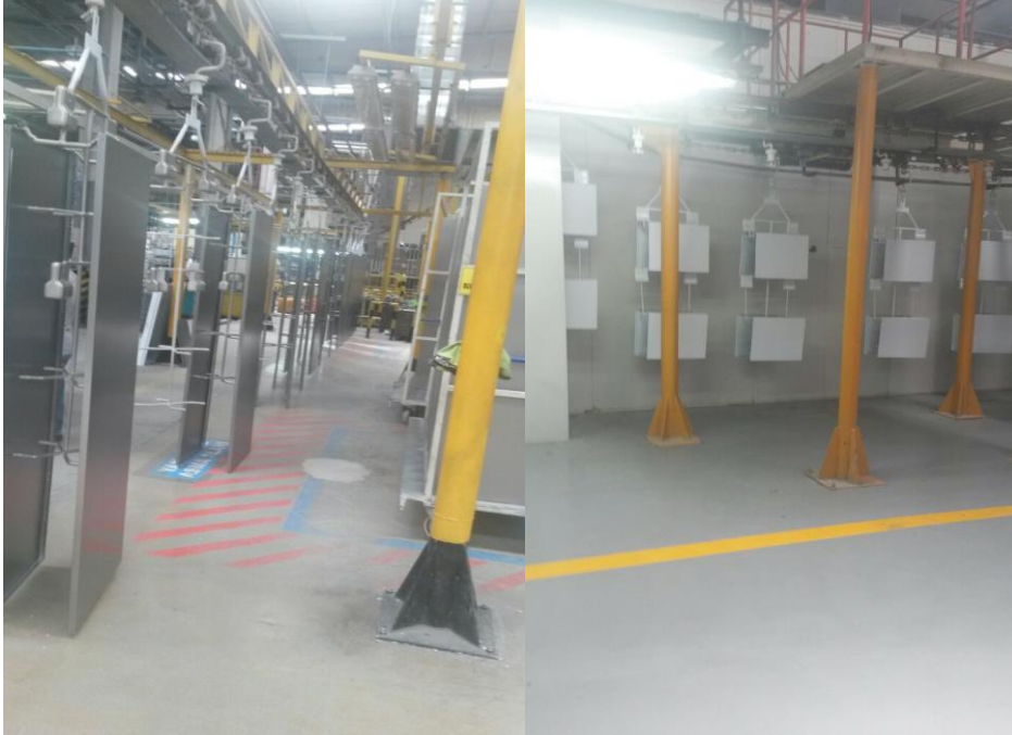
Şekil 9: Boyahane malzeme asma-alma (omuz seviyesi üstü hareket ve 5-15 kg arası değişen ağırlıkla eşya taşıma)
