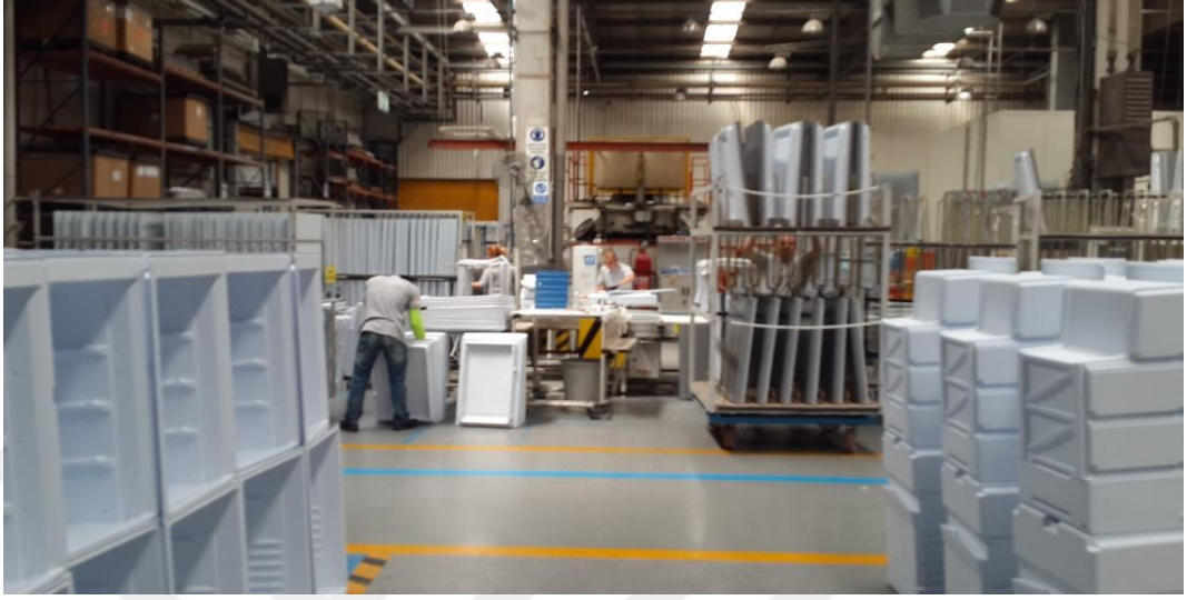
Şekil 8: Kapı poliüretan gruplama (buzdolabı kapıları montajı ve taşıma araçlarına taşınması)
