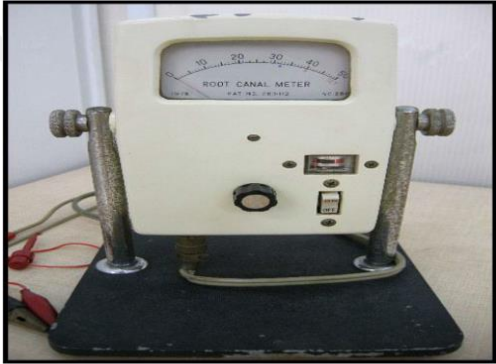
Resim 21: Tanıtılan ilk EAB The Root Canal Meter
