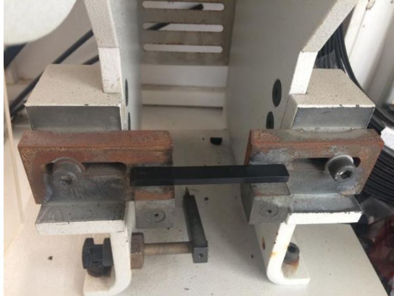
Şekil 3.25: Test numunesinin darbe cihazında konumlandırılması.
