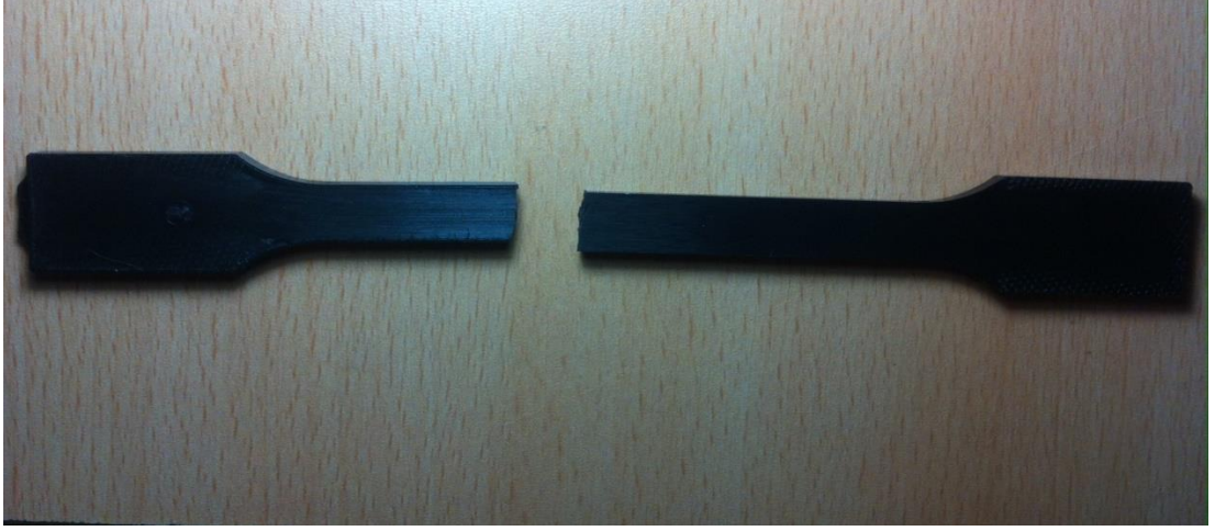
Şekil 3.21: Cam elyaf takviyeli çekme numunesinin kopma bölgesi.
