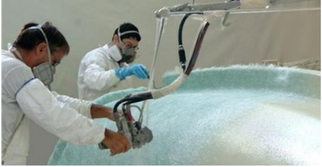
Şekil 1.13: Püskürtme ile kalıplama yöntemi (Şahin, 2014).
