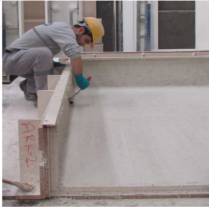
Şekil 4.3. Kalıba püskürtülen GFRC'nin rulolarla sıkıştırılması.
