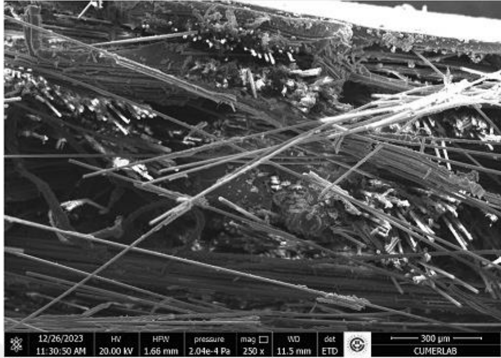
Şekil 4.29. \text{Al}_2\text{O}_3 mikropartikül takviyeli kompozitlerde fiber demetleri hasar mekanizmaları
