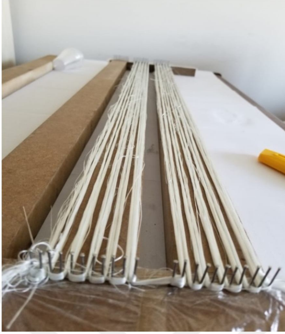
řekil 4.5. Liflerin kılavuzlar vasıtasıyla yerleřtirilmesi
