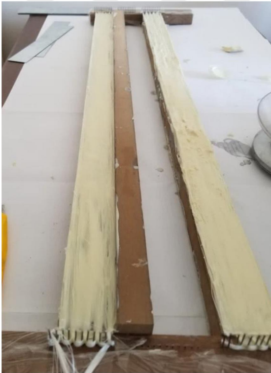
řekil 4.6. Numune zerine poliretan srlmesi
