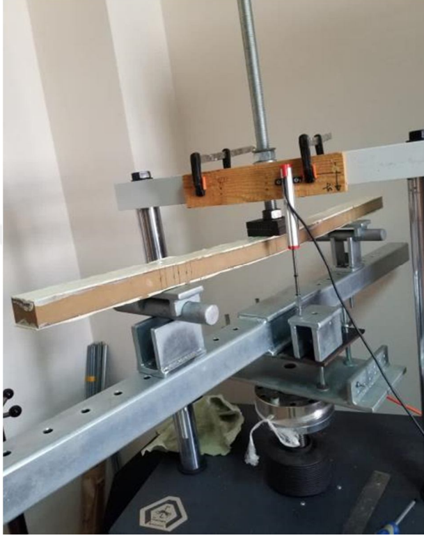
Şekil 4.10. kompozit kiriş 3 nokta eğilme deneyi
