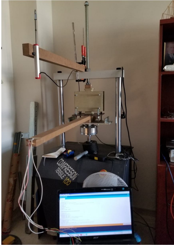
Şekil 3.3. MDF konsol kiriş titreşim testi
