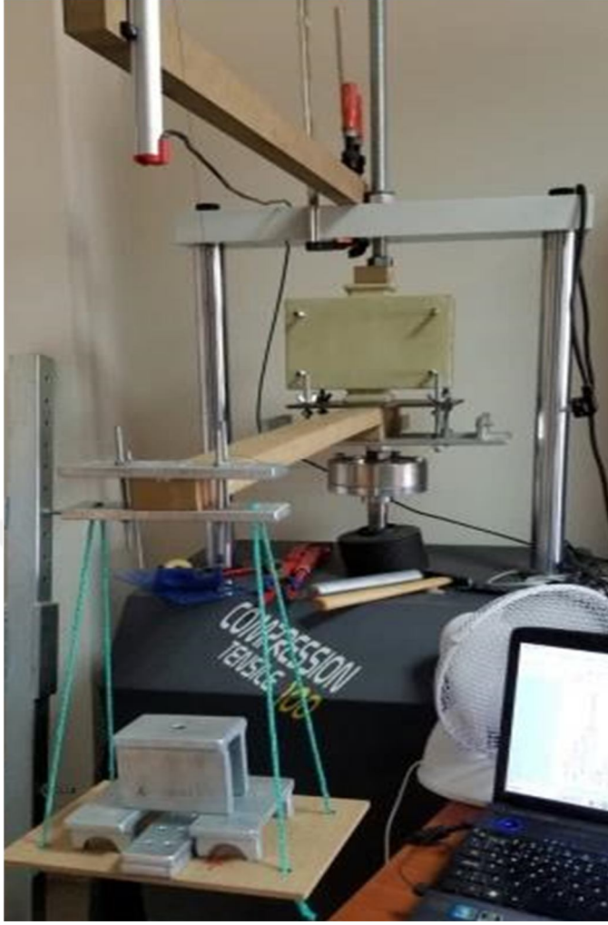
Şekil 3.4. Konsol kiriş statik eğilme deney düzeneği
