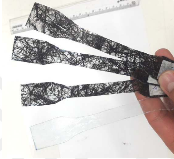
Görsel 6.8. Düz kalıplardan kesilen 400, 500, 600 °C CTP'leri ve Elyafsız CTP
