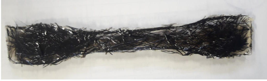
Görsel 6.6. Alçı Kalıptan Çıkarılan CTP
