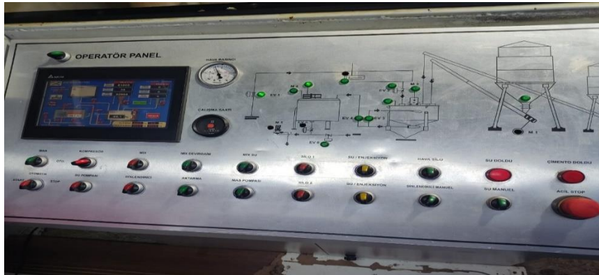
Şekil 5.5. Karışımın hazırlandığı tam otomatik dijital ünite.
