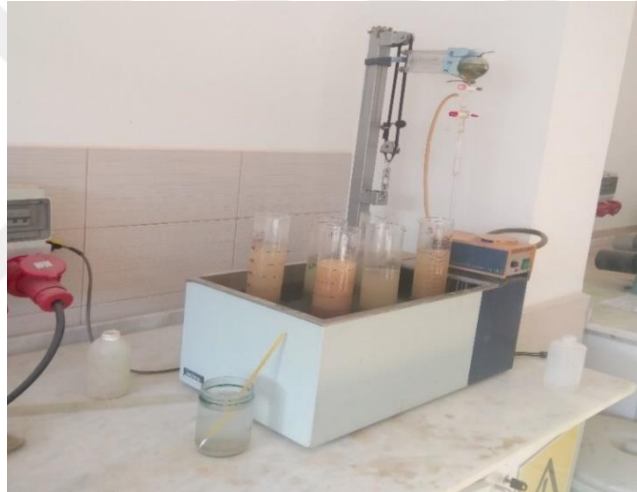
Şekil 4.8. TS 1900/2006-1'e göre uygulanan hidrometre deneyine ait görsel.
