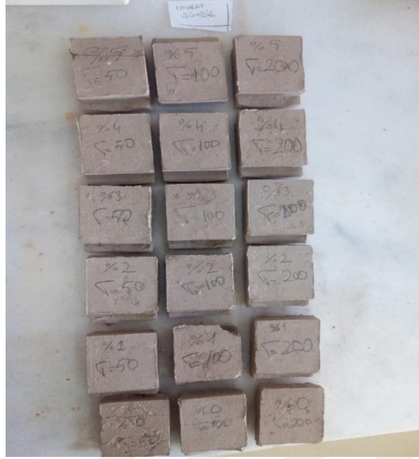
Şekil 4.20. Kesme kutusunda kesilen numunelere ait görsel.
