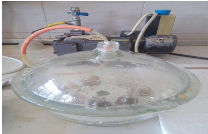
Şekil 4.12. Vakum ünitesine konulan deney numuneleri.
