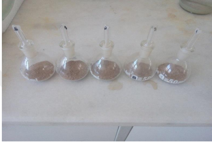
Şekil 4.11. Piknometre deneyine ait görsel.
