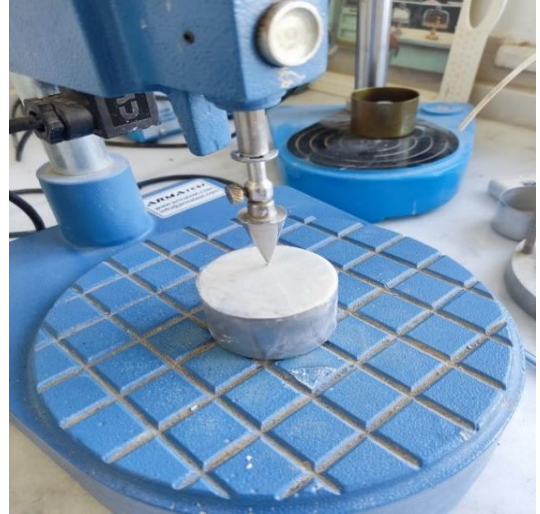
Şekil 4.4. Siltli zemin koni düşürme deneyi.
