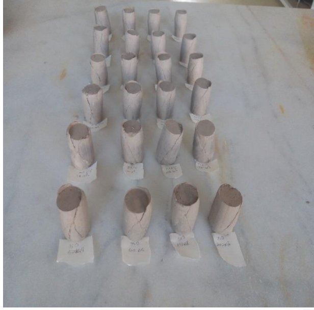
Şekil 4.27. UU deneyi yapılmış numuneleri yenilme şekilleri
