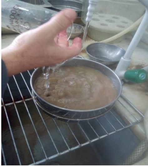
Şekil 4.9. Hidrometre deneyi sonrası numunelerin yıkanması ve elek takımından geçirilmesi.
