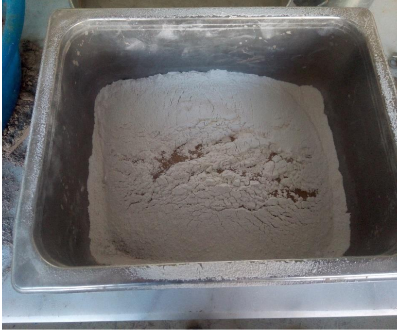
Şekil 4.2. CTP boru kesme atığı ile siltli numunenin kap içinde karıştırılması.
