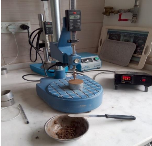
Şekil 4.4. Siltli zemin koni düşürme deneyi.
