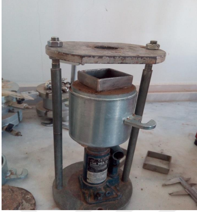
Şekil 4.18. Sıkıştırılan zeminden numune alınması işlemi.
