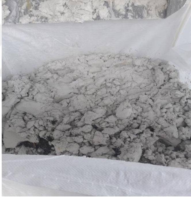
Şekil 3.1. CTP boru kesme atığının fabrikadan öğütülerek çıkmış hali.
