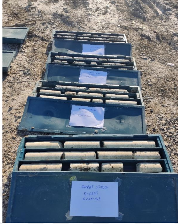
Şekil 5.7. Oluşturulan deney kolonlarına ait karot sandıklarının toplu fotoğrafı.
