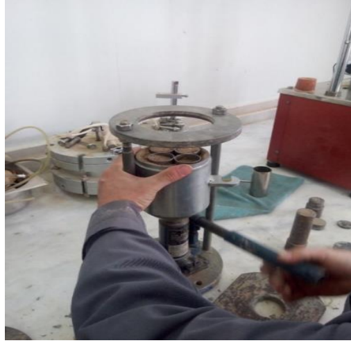
Şekil 4.24. Kompaksiyonu yapılan zeminden numune çıkarılması.
