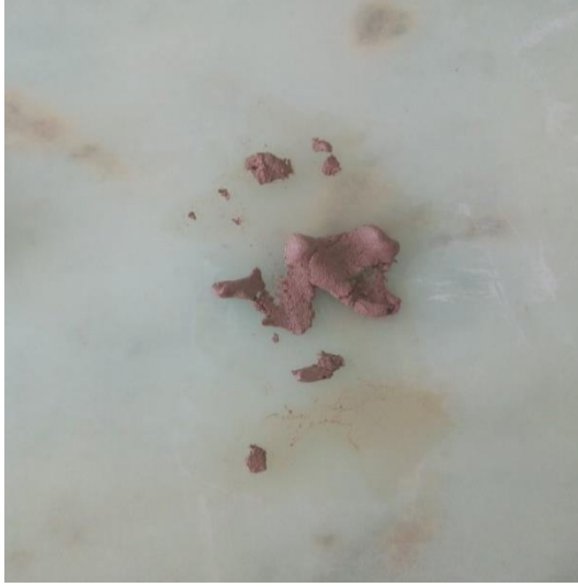
Şekil 4.3. Plastik limit yapılan siltli zemin ve CTP boru kesme atığının dağılmasına ait görsel.
