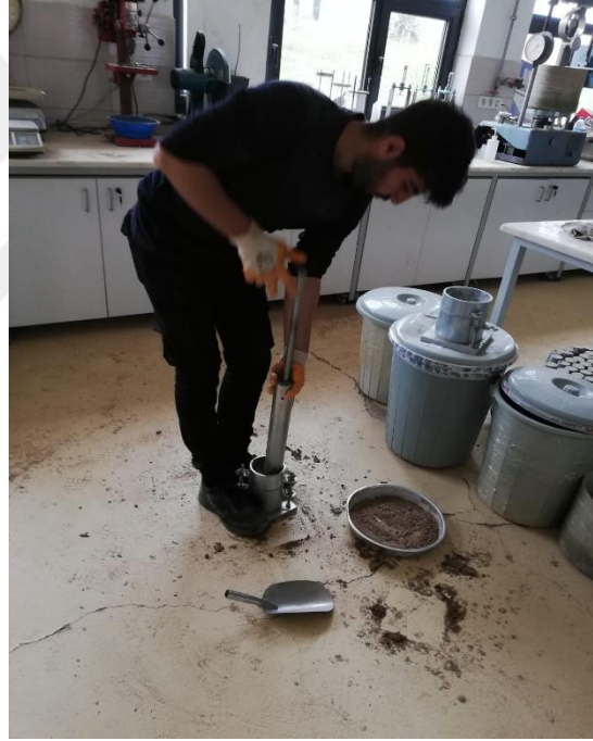
Şekil 4.15. Kompaksiyon deneyi uygulanması.
