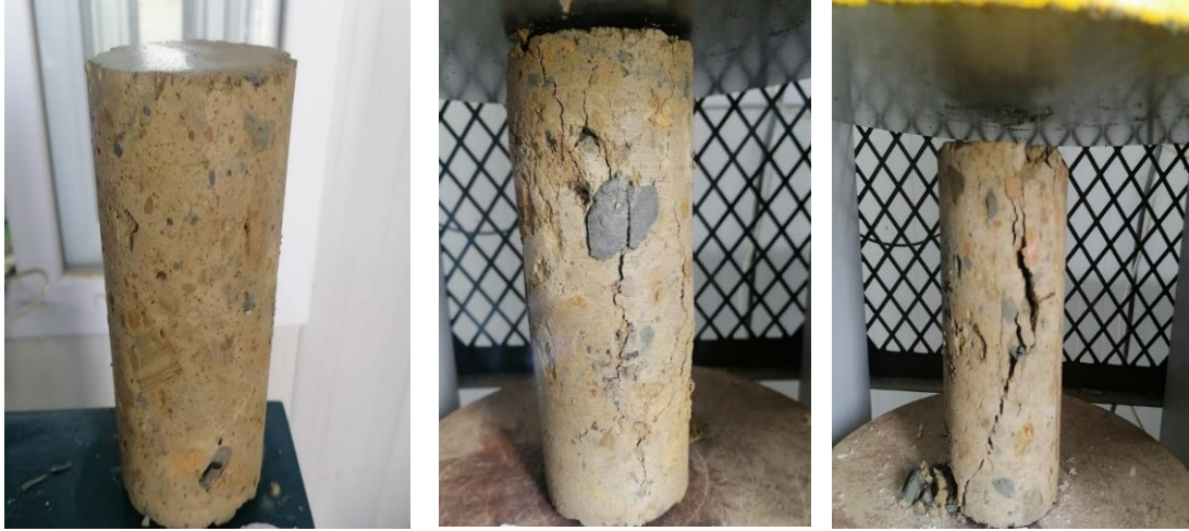
Şekil 5.8. DSM kolonu karot numunesi kırımı.
