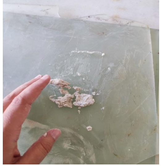
Şekil 4.3. Plastik limit yapılan siltli zemin ve CTP boru kesme atığının dağılmasına ait görsel.
