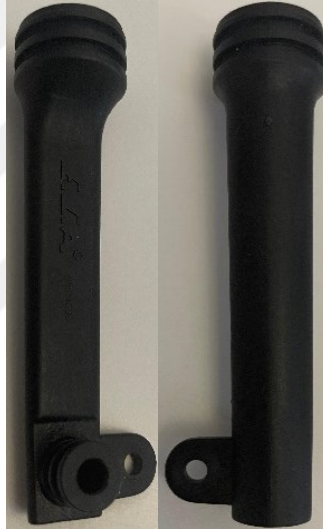
Şekil 24. PPS-GF30 malzemesinden üretilen karışım çubuğu parçası
