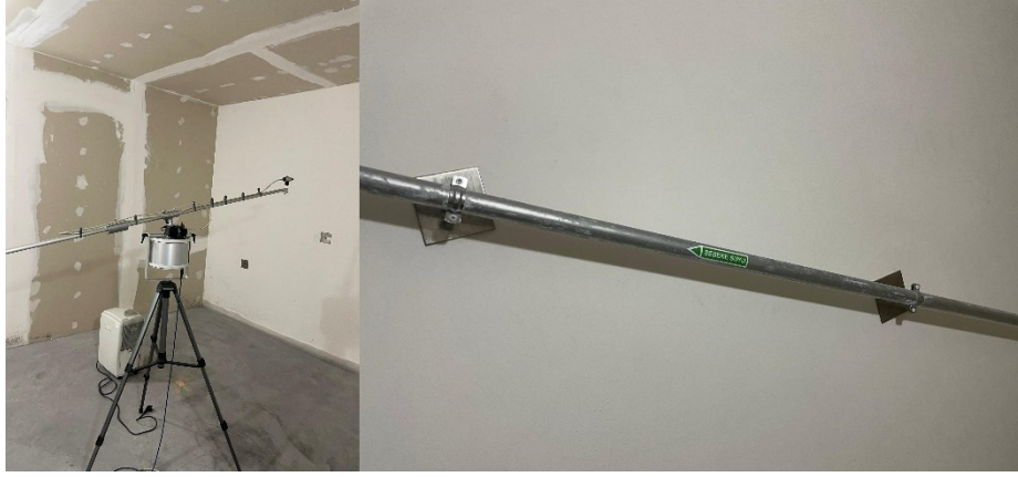
Şekil 31. Akustik ölçüm odası ve deney borusu
