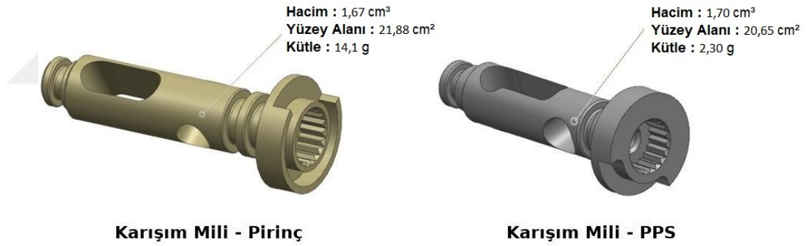
Şekil 37. Pirinç ve PPS malzemeden tasarlanan karışım mili
