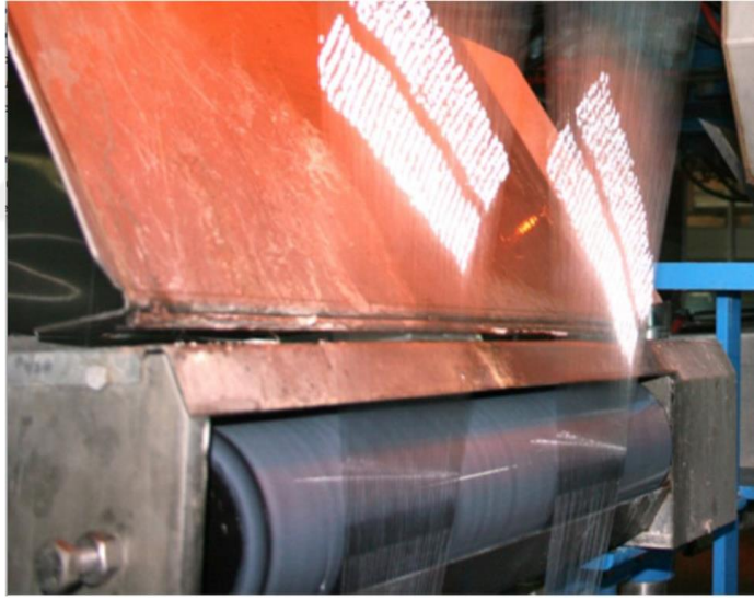
Şekil 3.4. Cam elyafın su bazlı poliüretan dispersiyon reçinesi ile merdane üzerinde kaplanması
