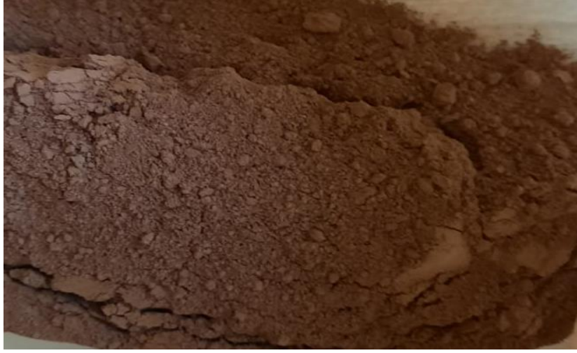
Resim 3.2 Hematit toz hale getirilmesi.
