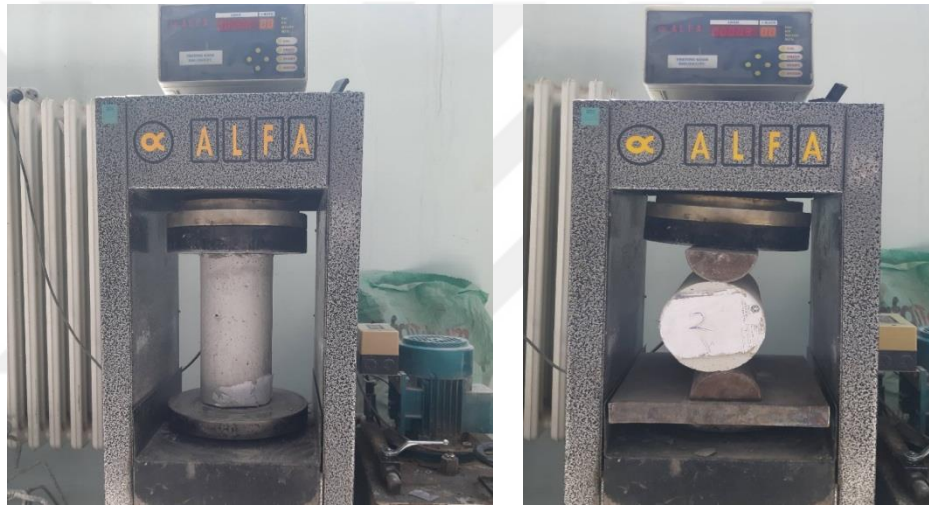
Şekil 3.9. Betonun basınç ve yarma dayanımının belirlenmesi
