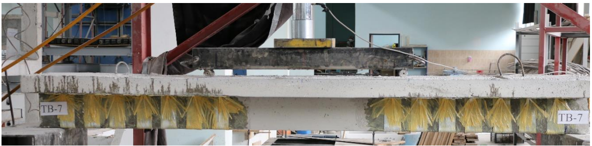
Şekil 3.26.Kiriş gövdesinin tüm yüksekliğini U-Sargılama ve cam fiber ankraj (TB-6) kullanma
