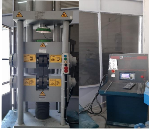
Şekil 3.10. Donatı çeliği çekme deneyi
