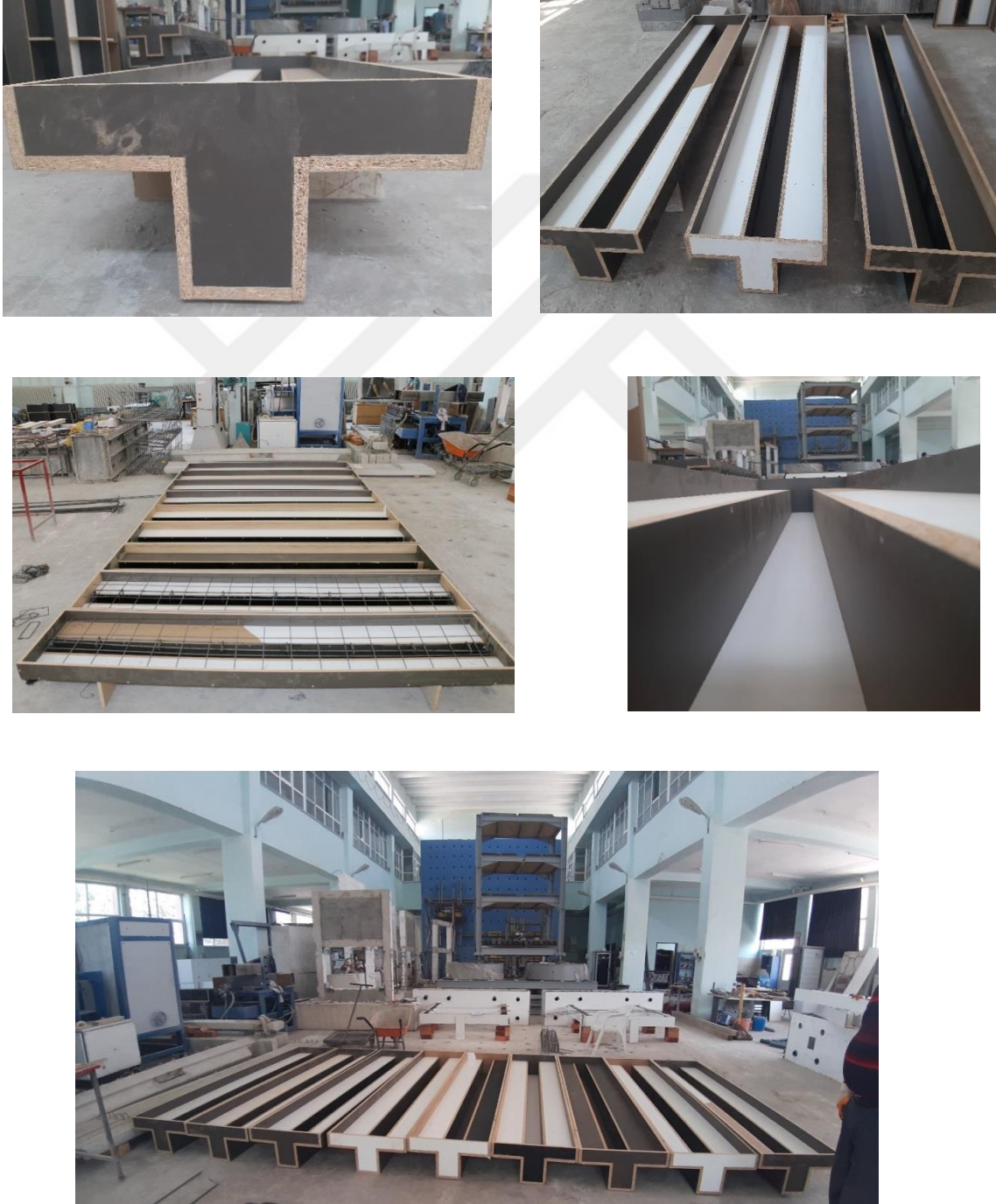
Şekil 3.3. Beton dökümüne hazır numune kalıpları
