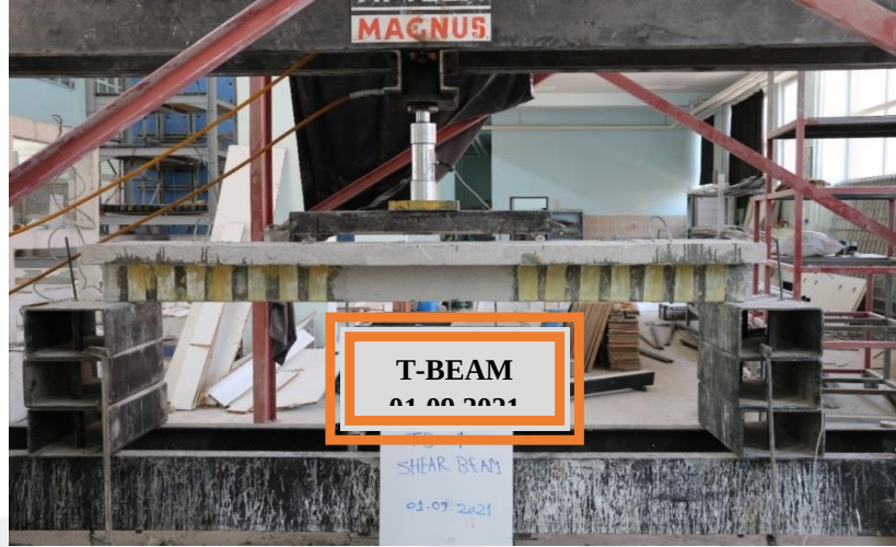
Şekil 3.19. Dıştan cam fiber takviyeli polimer kompozitler ile güçlendirilmiş kirişler
