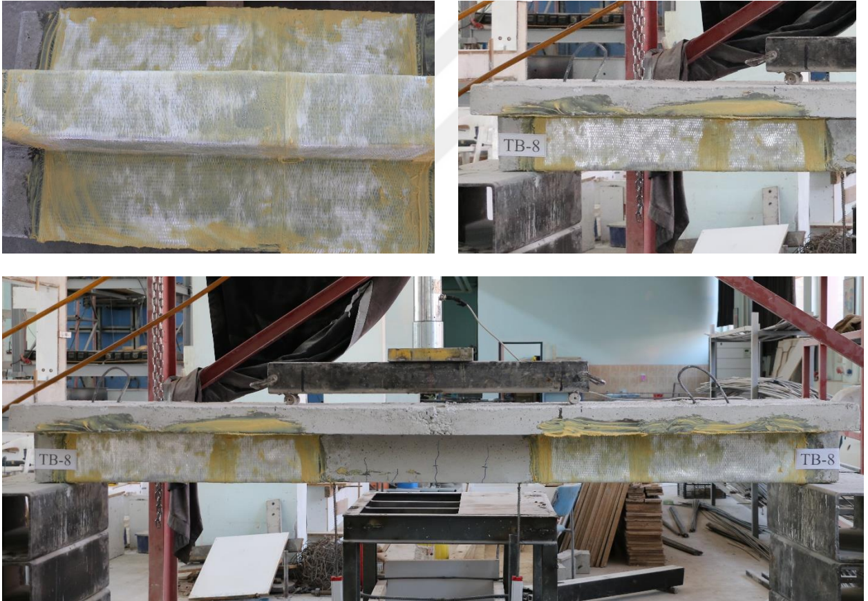
Şekil 3.27. Kiriş kesme alanı boyunca sürekli cam fiber kumaş ile U-Şekli güçlendirme (TB-8)
