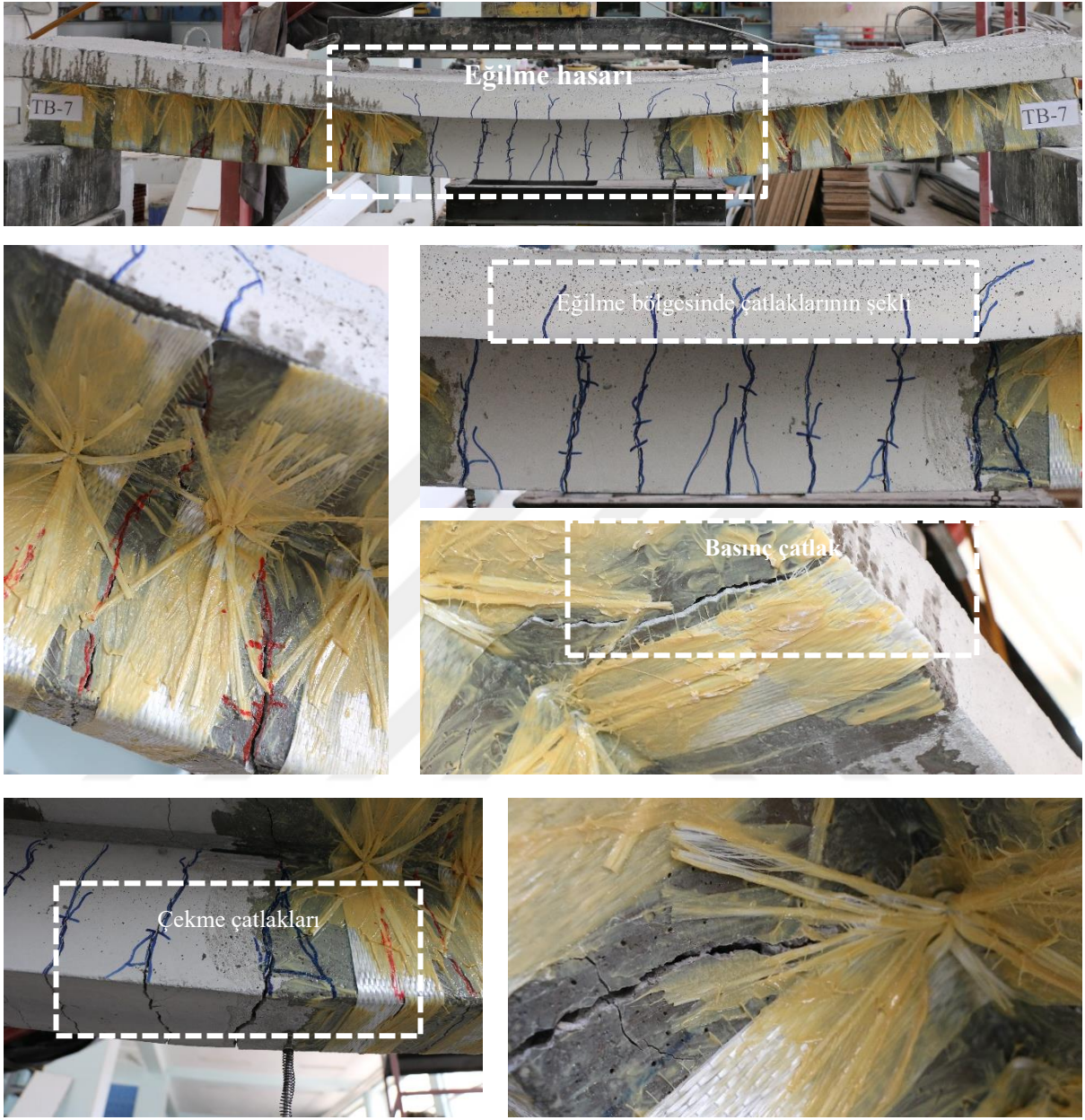
Şekil 4.19. TB-7 numunesinde oluşan hasarların görüntüsü
