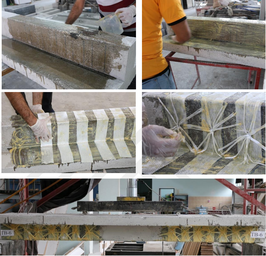
Şekil 3.25.b. Beton yüzeyine cam fiber kumaşların ve ankraj uygulanması
