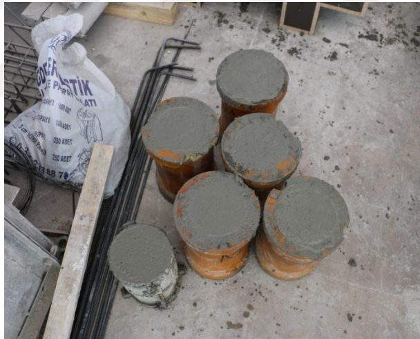
Şekil 3.8. Beton dökümü sırasında alınan silindir numuneler
