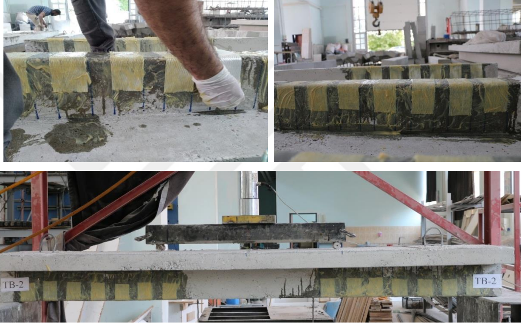
Şekil 3.21. Gövde Yüksekliğinin Yarısını U-Şekli Sargılama (TB-2)
