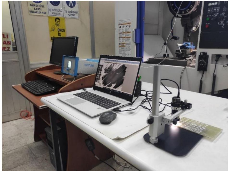
Şekil 5.19. Deformasyon görüntülerinin mikroskopla çekilerek bilgisayara aktarılması
