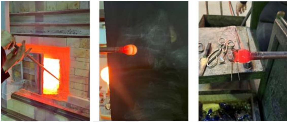
Görsel 3. 17. Sıcak camda fırından cam alma ve cam küre üfleme süreci (İrem Yılmaz Fotoğraf arşivi)
