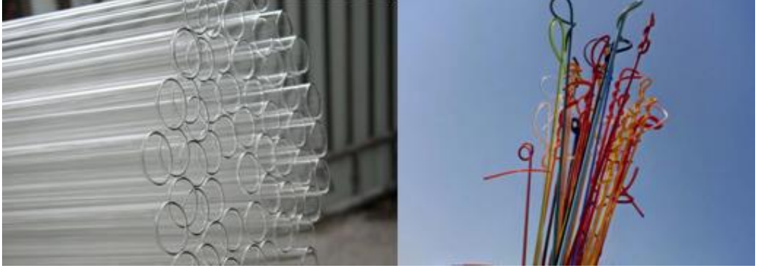
Görsel 3. 20. Şeffaf borosilikat tüp ve soda camı renkli çubuk örnekleri
