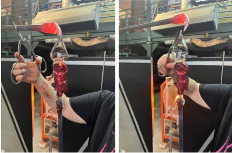
Görsel 5. 45. Kadeh ayağının figüratif gövde ile birleştirilmesi (İrem Yılmaz fotoğraf arşivi)
