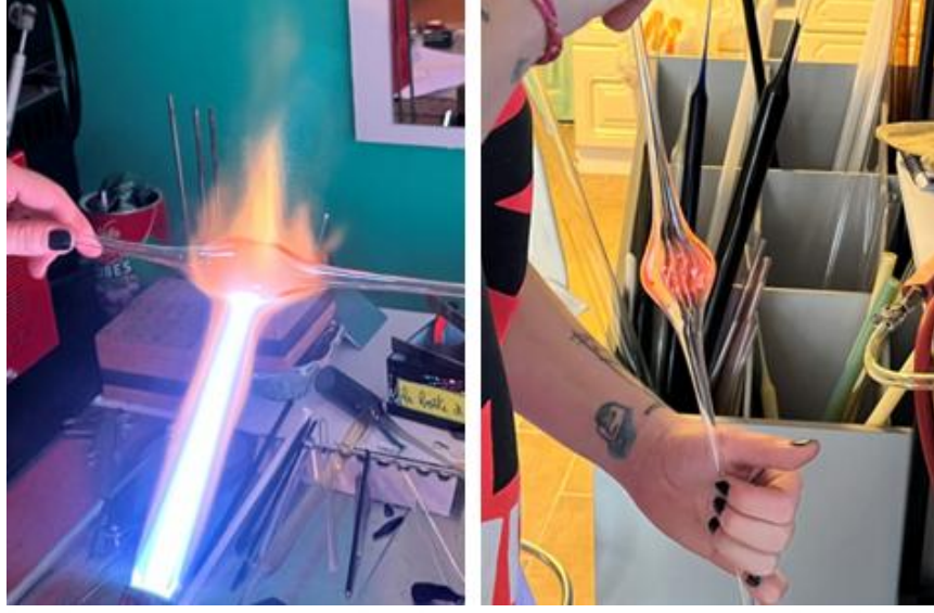
Görsel 5. 9. Şeffaf cam tüpün ısıtılması ve üflenmesi (İrem Yılmaz fotoğraf arşivi)
