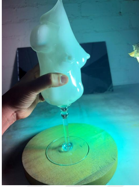
Görsel 5. 59. UV ışığı ile yapıştırıcının aktifleştirilmesi (İrem Yılmaz fotoğraf arşivi)
