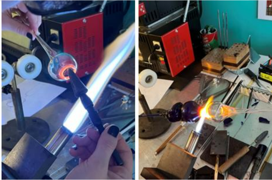
Görsel 5. 10. Kadeh ayağının grafit el aletiyle genişletilmesi ve figür ile birleştirmesi (İrem Yılmaz fotoğraf arşivi)
