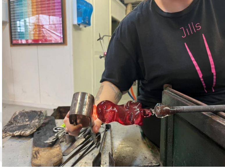
Görsel 5. 42. Eklenen cam parçanın düzleştirilmesi (İrem Yılmaz fotoğraf arşivi)
