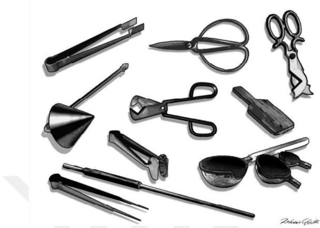
Görsel 3. 8. Sıcak cam şekillendirmede kullanılan en yaygın el aletleri. İllustrasyon: Rıdvan Çelik (E. Kula 2005)
