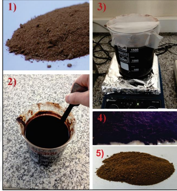
Şekil 4.2 Çam kozalağı tozlarının kimyasal arındırma işlem süreci; 1) arındırmadan önceki hali, 2) sodyum hidroksitin sulu çözeltisinin eklenmesi, 3) manyetik karıştırıcıda 48 saatlik karıştırma süreci, 4) kurutma süreci ve 5) kurutmadan sonraki hali (Kişisel arşiv, 2017)
