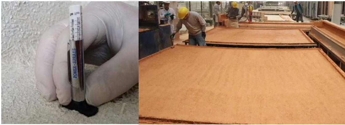
Şekil 2.21. Kalınlık ölçümü ve son kat düzeltme.
