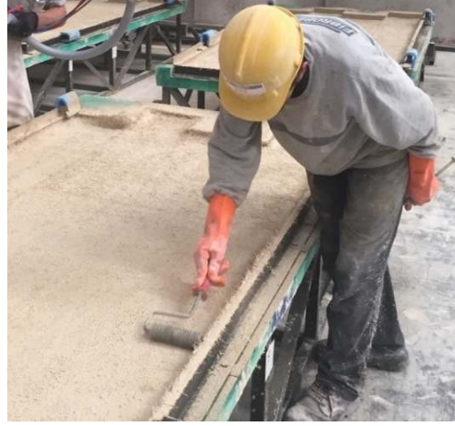
Şekil 2.19. Sıkıştırma işleminde kullanılan rulolar ve rulolama [40].
