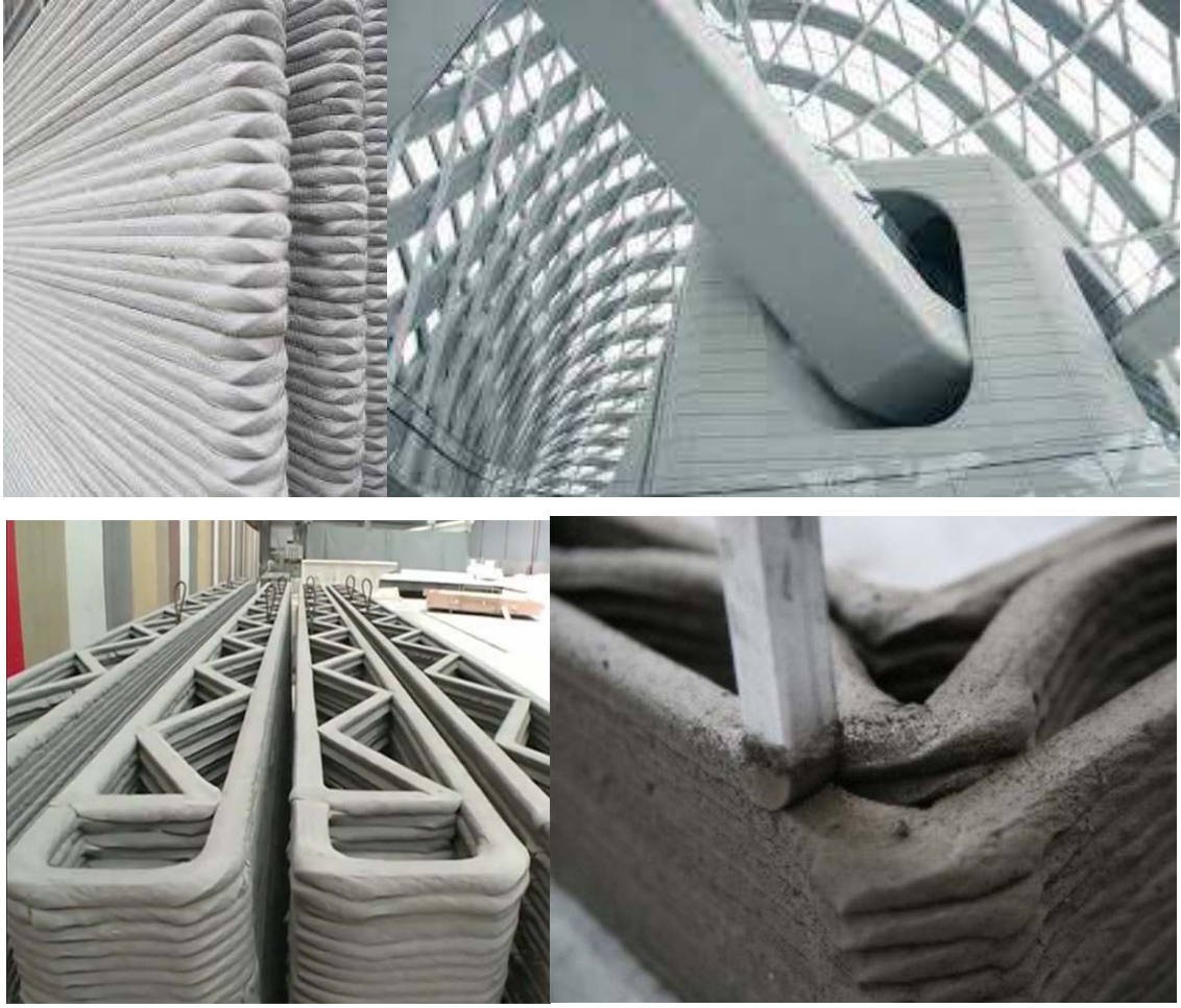
Şekil 2.25. 3B Yazıcı ile basılmış yapı elemanları [56].
