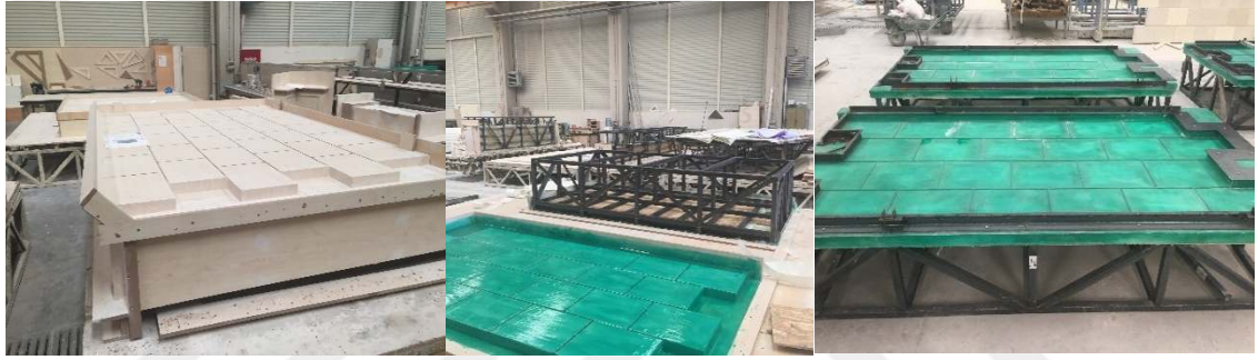
Şekil 2.15. Polyester kalıbın tasarımı ve yapım aşamaları.
