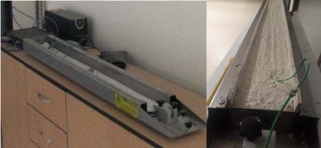
Şekil 3.13. Büzülme deney cihazı test aşaması.
