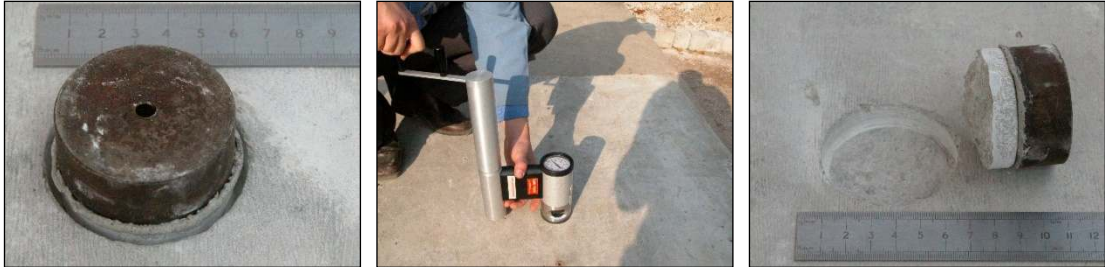
Şekil 2.52. Doğrudan çekme dayanımı deneyi yapılışı [80].
