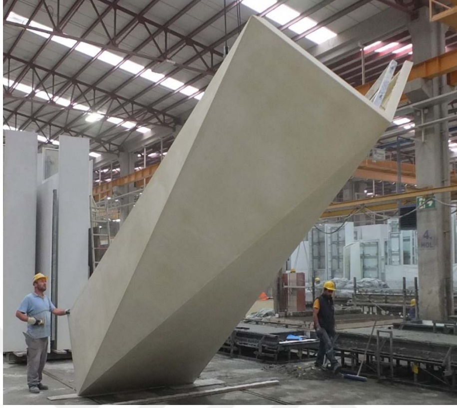
Şekil 2.30. GRC-CTB ürünlerin kalıptan sökümü.
