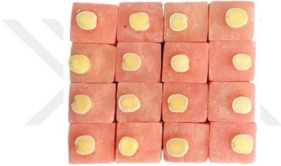
Resim 3.3 Preparasyonu tamamlanmış ve zımparalanmış numuneler
