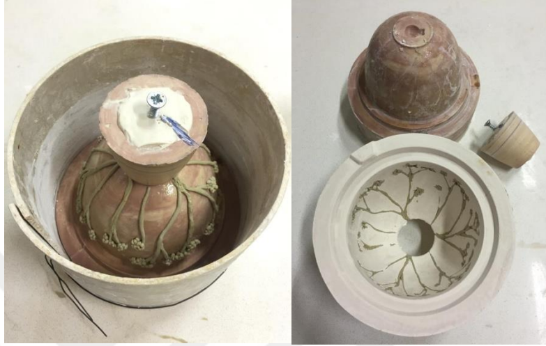
Görsel 6.11. Pozitif kalıp alma aşaması, (Fotoğraf: Duygu Yıldırım)
