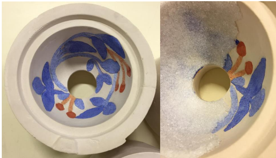
Görsel 6.14. Rölyef detaylara renkli cam yerleştirme ve ikinci katman şeffaf cam yerleştirme, (Fotoğraf: Duygu Yıldırım)
