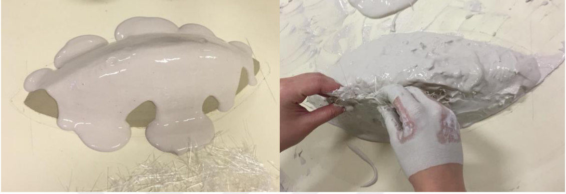
Görsel 6.29. Kalıp alma işlemi, (Fotoğraf: Duygu Yıldırım)
