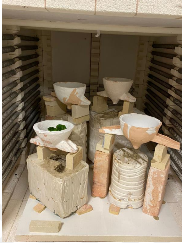
Görsel 3.4. Cam yükleme yapılmış pota, (Fotoğraf: Ekrem Kula)
