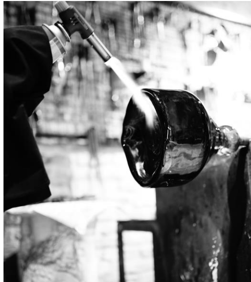
Görsel 4.12. Alazlama Aşaması/ Fotoğraf: Serhat Özdemir
