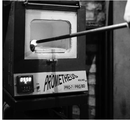
Görsel 4.9. Renklerin Ön Isıt ma Fırınından Alınması// Fotoğraf: Serhat Özdemir
