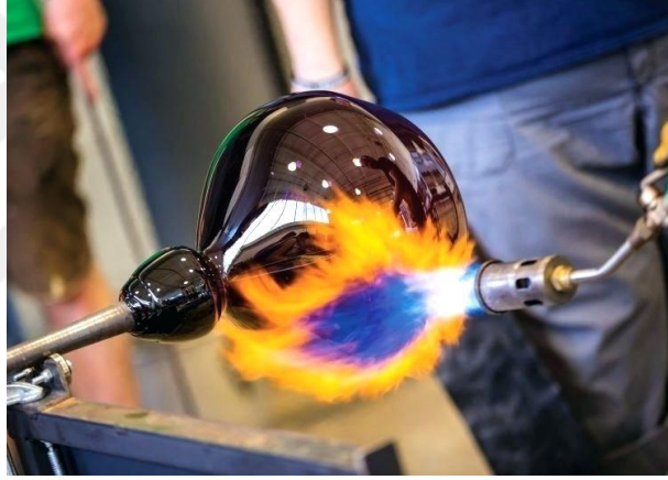
Görsel 3.2. Cam Üflemede Ara Isıtma Amaçlı Kullanılan Pürmüz (http-33).
