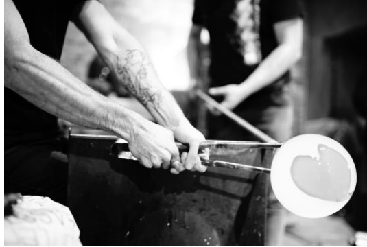
Görsel 4.10. Alazlama Yöntemiyle Cam Üretim Aşaması/ Fotoğraf: Serhat Özdemir
