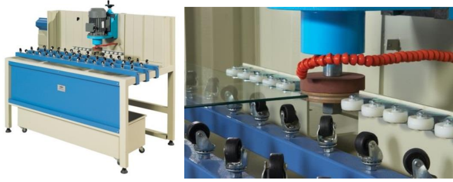
Görsel 2.10. Sol: Elmas diskli rodaj makinesi, Sağ: Rodaj işlemi detay ( https://ccmmakine.com/tr/ccm-manuel-cam-rodaj-makineleri/ , Erişim Tarihi: 14.04.2019)
