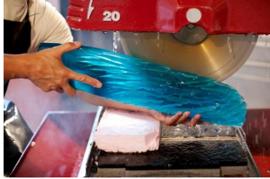
Görsel 3.14. Testere ile biçimlendirme, Alex Bernstein ( http://alexbernsteinglass.com/process/ , Erişim Tarihi:24.04.2019)
