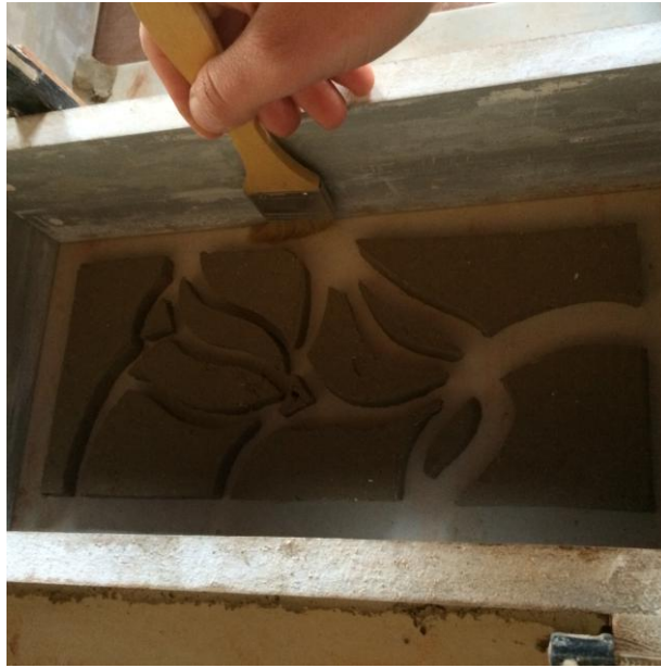
Görsel 3.8 Modelin alçıdan çıkmasını kolaylaştırma işlemi
