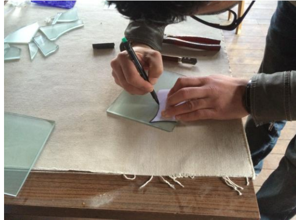
Görsel 3.2 Karton kalıp yardımı ile parçaların çizilmesi
