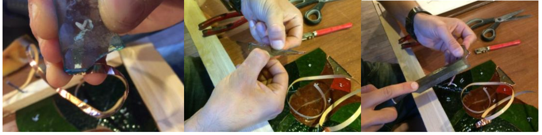
Görsel 3.41 Folyo ile kaplama işlemi
