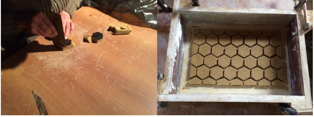
Görsel 4.7 Cam parçalarına yükselti kazandırma ve alçı dökümü
