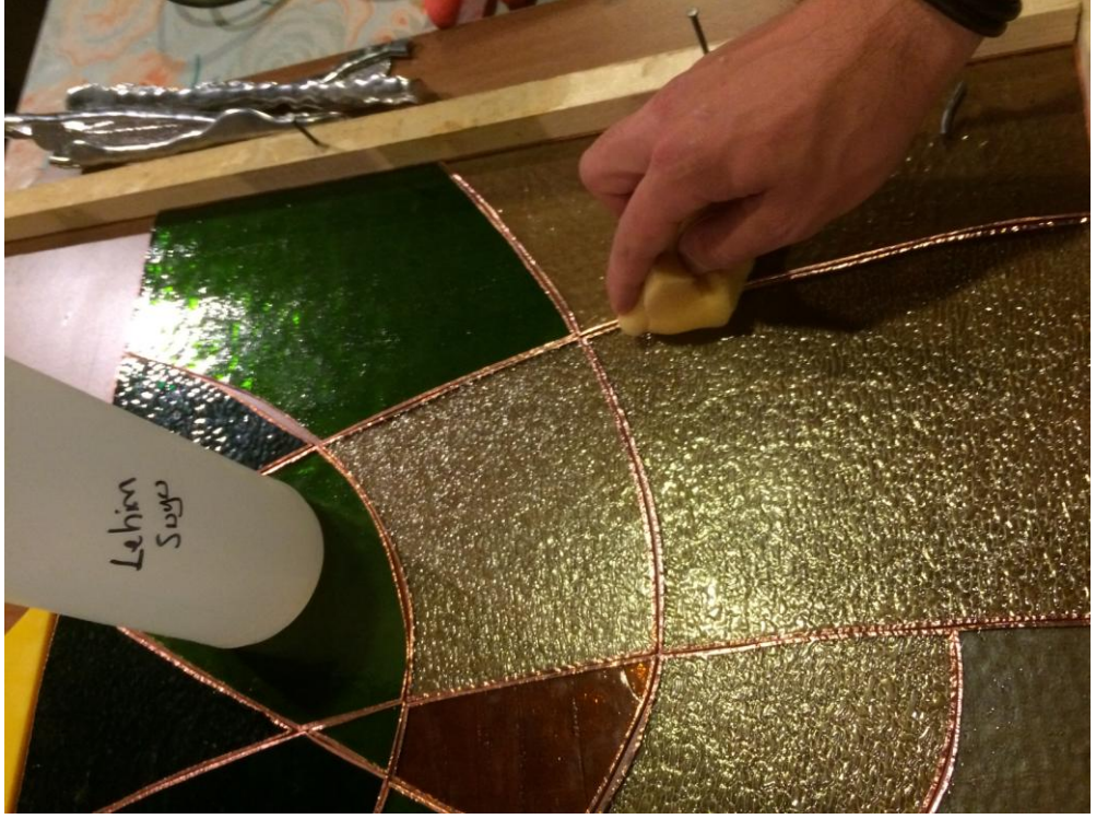
Görsel 4.22 Lehim suyu ile temizleme
