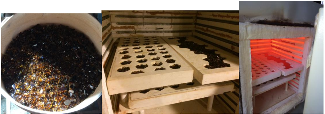
Görsel 4.6 Camları yerleştirme ve fırınlama
