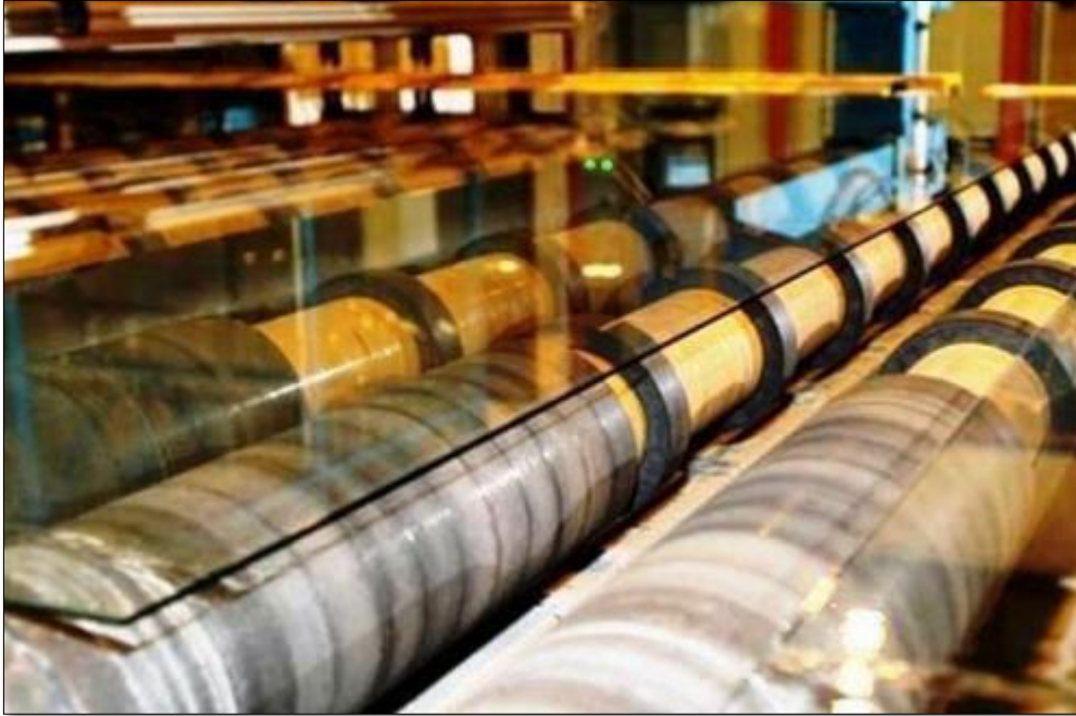
Şekil 2.4. Döner çelik silindir ile camın kontrol edilmesi (Kaynak: Glass for Europe, 2014)
