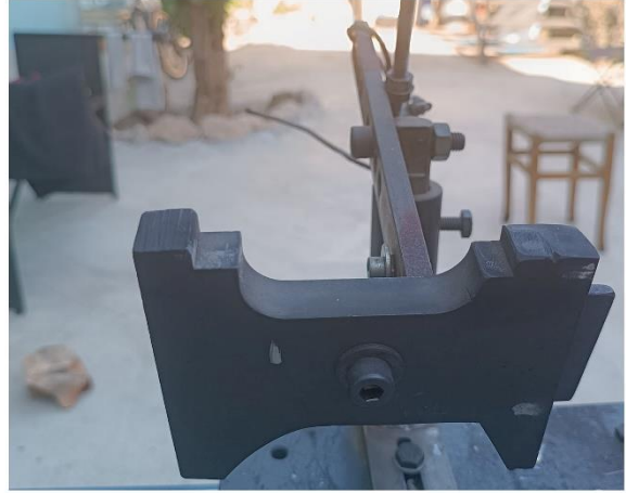
Görsel 4. 4. Cam tornada grafit kalıp
