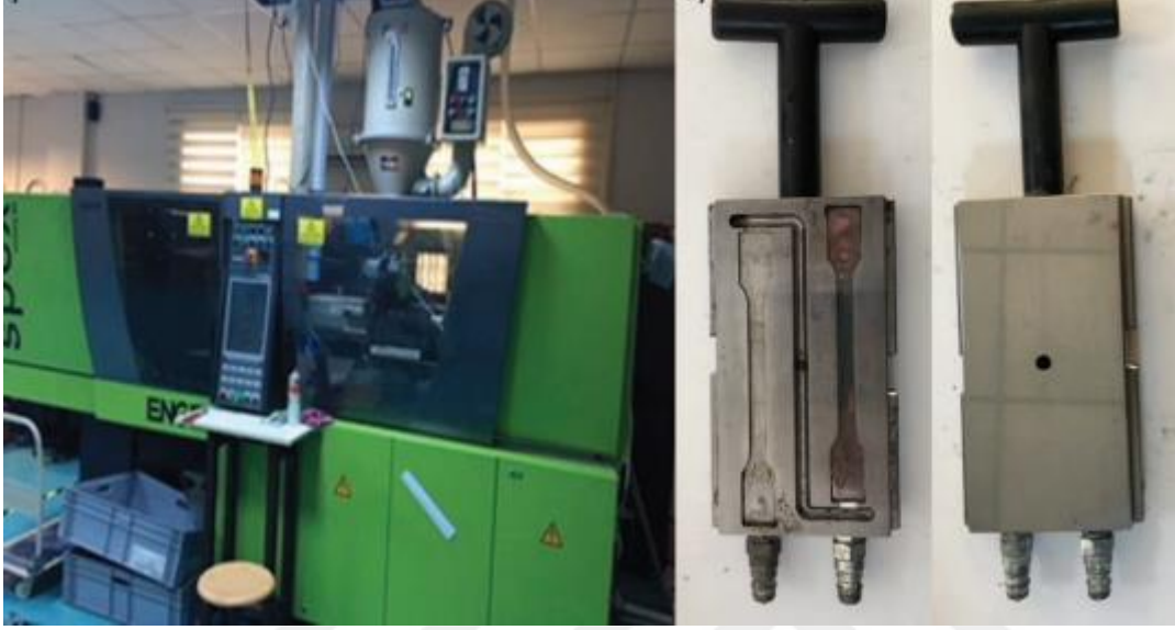
Şekil 4.2 Kullanılan enjeksiyon makinesi ve test numunesi kalıbı
