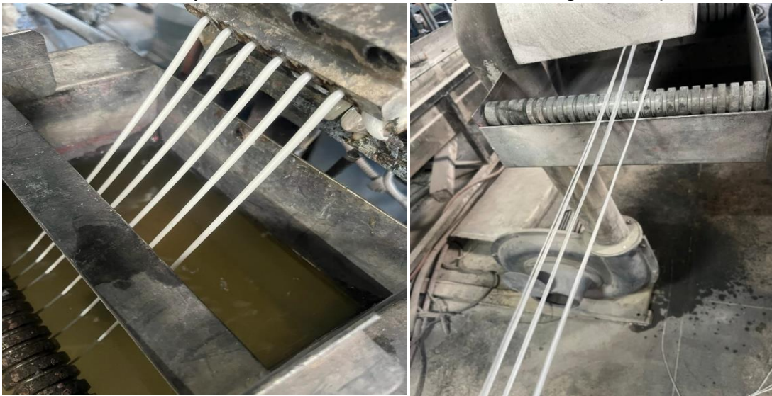
Şekil 4.1 Ekstrüzyon makinesinde numunelerin üretimi
